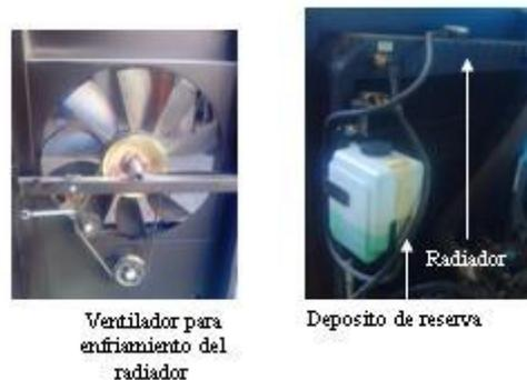
FIGURA 2.17. SISTEMA DE ENFRIAMIENTO POR LÍQUIDO PARA EL MOTOR
