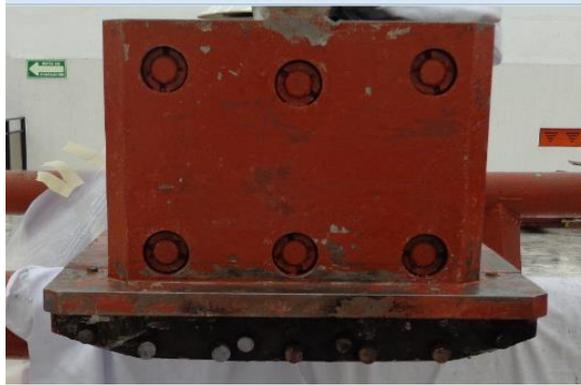
**Figura. 4.40 núcleo polar sin la barra amortiguadora**
