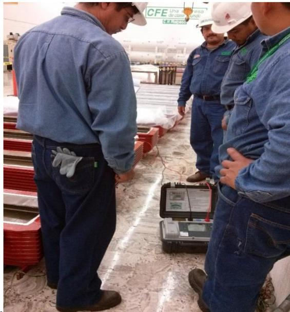
**Fig. 4.67 prueba de resistencia de aislamiento a los polos corregidos.**
