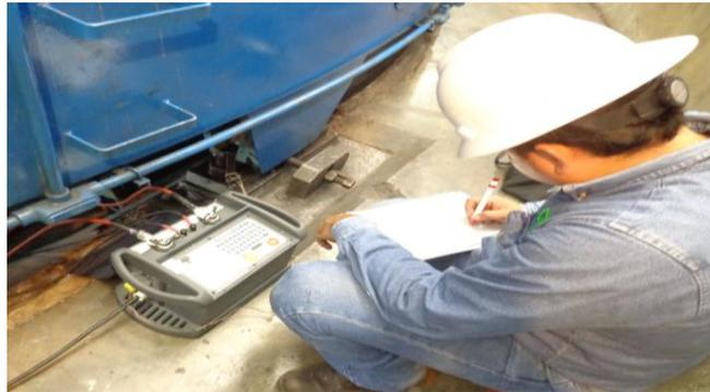
Se efectúa pruebas de ducter conexiones polares y devanado amortiguador en la parte inferior de los polos.
