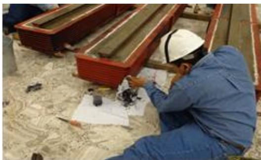
**Figura 4.50. Limpieza de polos desmontados**
