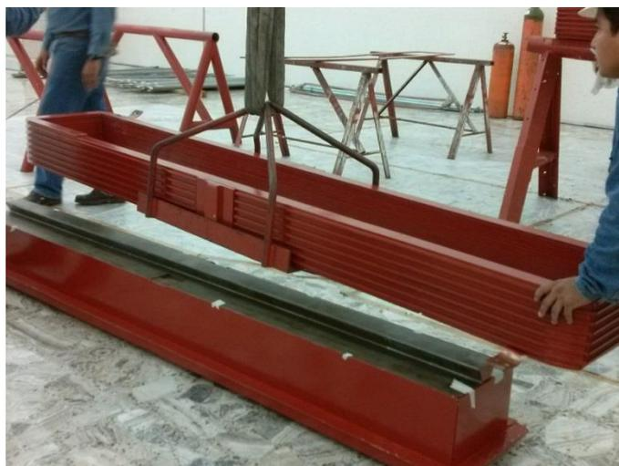
**Fig. 4.59 Colocación de la bobina al núcleo polar.**
