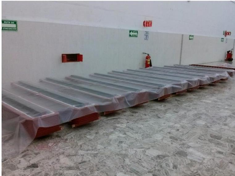
**Fig. 4.66 Polos listos cubiertos con nylon.**
