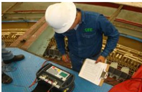
**Fig. 4.90 Iniciando la prueba de resistencia de contacto en la parte superior**
