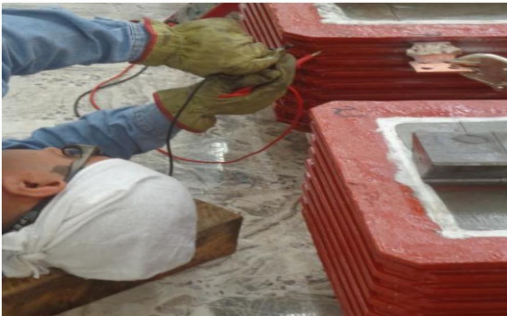
***Figura 4.46. Prueba de caída de tensión entre espiras al polo 35***
