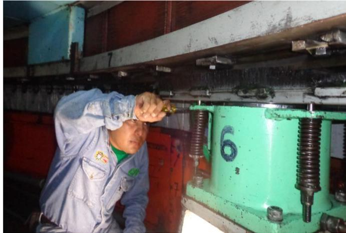
Se efectúan pruebas de operación de gatos de frenado. Operación normal.
