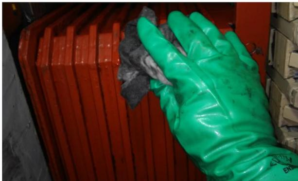
**Figura 4.71 Se realiza limpieza a la parte inferior de los polos montados y aspas de ventilación**
