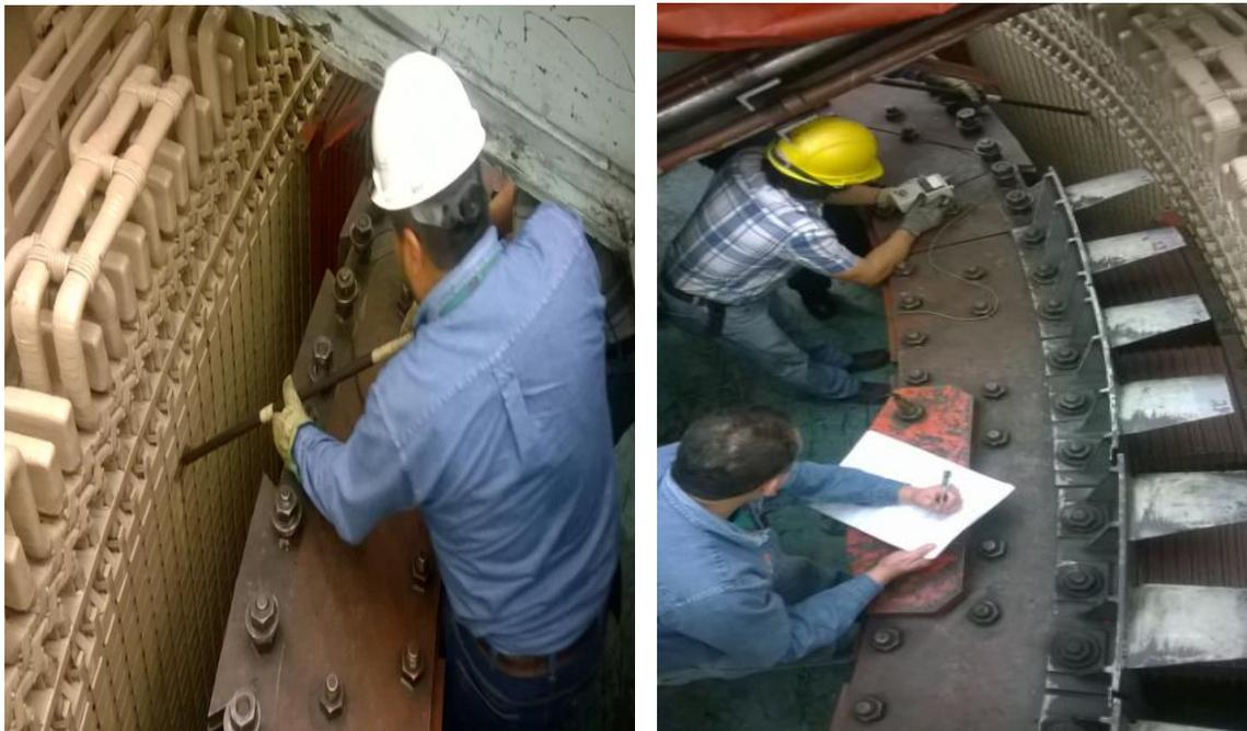
**Fig. 4.2.22** Realizando pruebas al estator LAPEM con ayuda del departamento eléctrico
