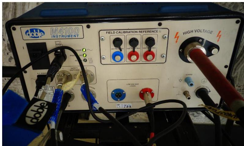
**Fig. 4.2.13 Equipo de Factor de Disipación**
