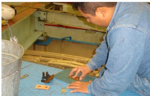
**Fig. 4.81 cambio de tornillería a todos los 56 polos**
