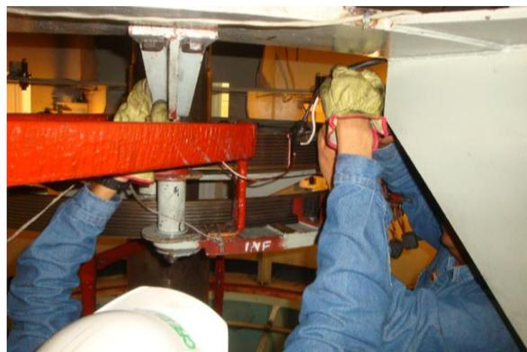
**Figura 4.26. Colocación del potencial para la prueba en corriente alterna**
