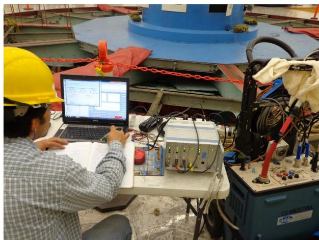
**Fig. 4.2.17 Personal de LAPEM realizando pruebas eléctricas al estator del generador**
