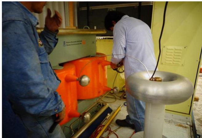
**Fig. 4.2.9 Instalación del equipo para la prueba de alta tensión**
