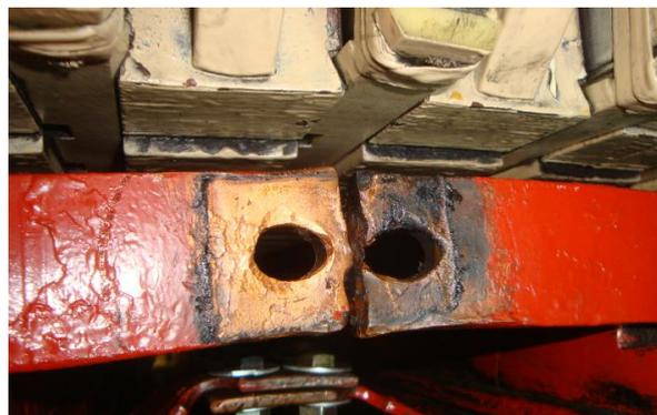
**Fig. 4.85. Barra amortiguadora en mal estado**
