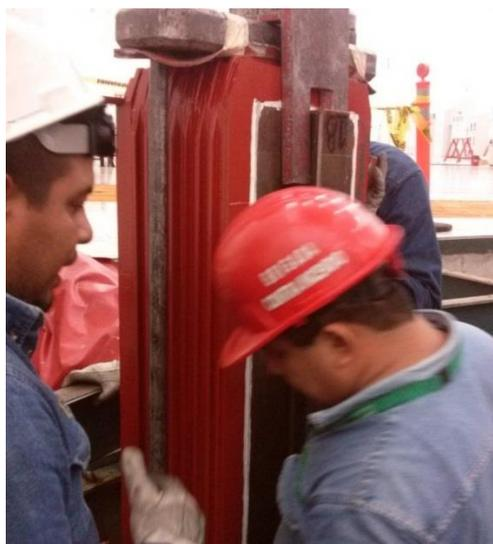
**Fig. 4.75 Colocando el polo al rotor.**
