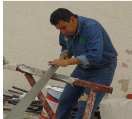
**Figura 4.34. Identificación de las cuñas y contracuñas de los polos extraídos y su respectivo mantenimiento.**
