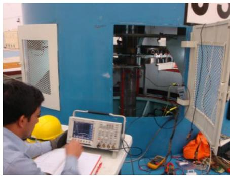
**Personal de LAPEM realizando prueba de impulso a la frecuencia en baja tensión**
