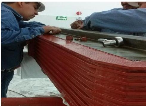
**Figura 4.51 Mantenimiento de polos desmontados**
