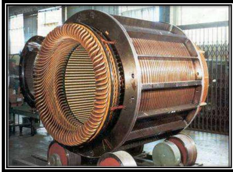
**Fig. 3.3.2. Estator, armadura o inducido de un generador o alternador síncrono**
