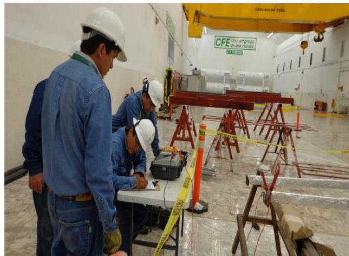
**Figuras.4.24 Realización de la prueba de resistencia de aislamiento al aislamiento nuevo**
