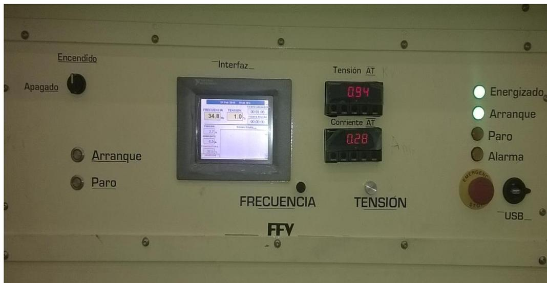
**Fig. 4.2.11** Inicio de la prueba de alto potencial
