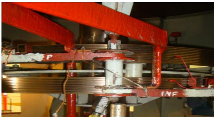
**Figura 4.3. Anillos rozantes en corto circuito para hacer la prueba**
