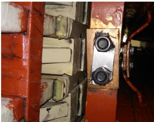
**Fig. 4.80. Conexión de las barras amortiguadoras.**
