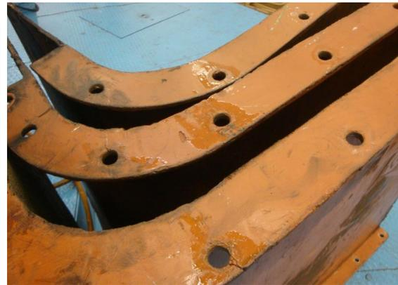
**Fig. 4.1.6 Desmontaje de las tolvas de fibra de vidrio parte superior**
