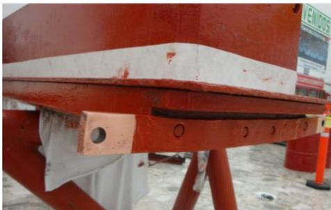
**Figura. 3. 45 barra colocada y pintada con barniz aislante.**
