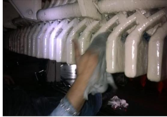
**Fig. 4.1.11 Limpieza de cabezales parte inferior**
