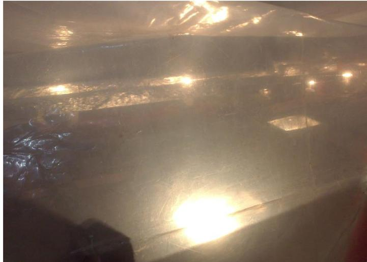
**Figura. 4.23 Barras de excitación sometidas a temperatura por el método de secado**
