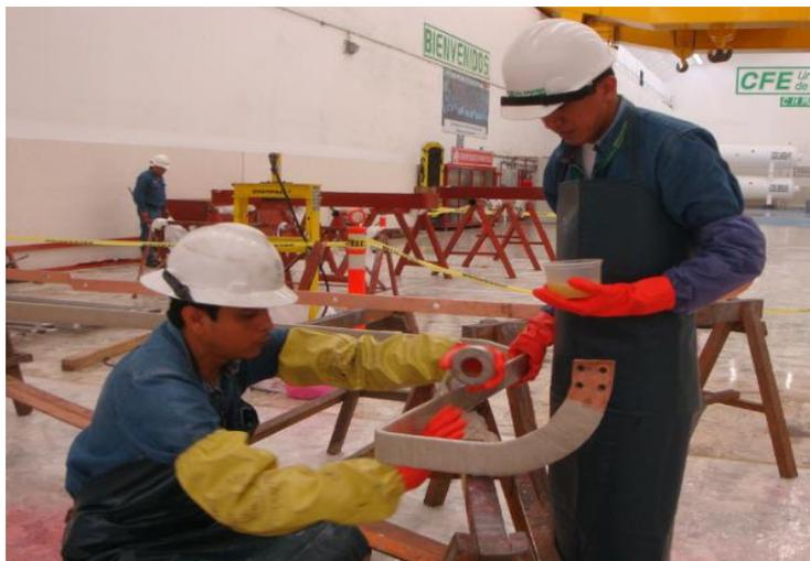
**Figura. 4.18. Colocación de cinta de mica con resina y cinta de fibra de vidrio.**
