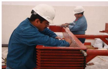
**Figura. 4.48 Limpieza a la bobina polar**
