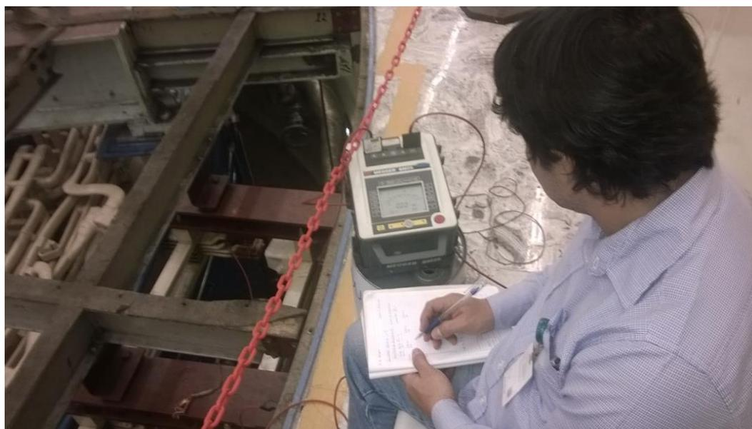
**Fig. 4.2.13 Personal de LAPEM realizando la prueba de R.A.**
