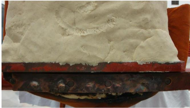
**Figura. 4. 38 Masa comestible para atrapar el calor durante la extracción de la barra amortiguador.**
