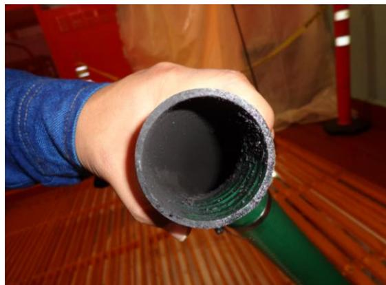
De igual manera se limpió todos los ductos por donde pasa los residuos del polvo que suelta las balatas del frenado. Y se reemplazó algunos ductos de manguera corrugada de 2 pulgadas por nuevas.
