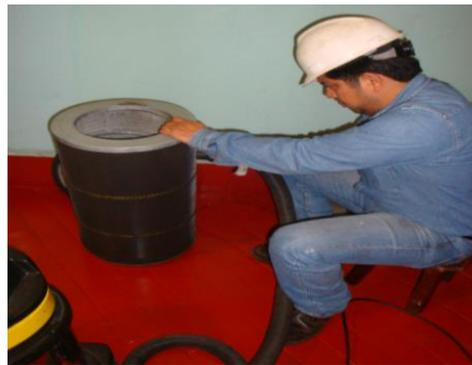
**Fig. 4.95 Limpieza al extractor de polvo de balata y filtro**
