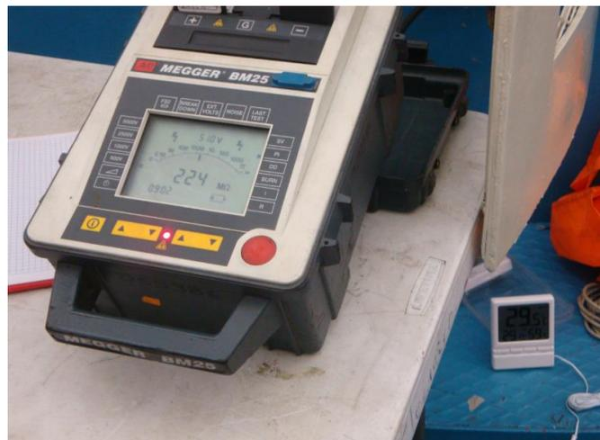
**Fig. 4.1.0** Medición de resistencia de aislamiento en el campo del generador.
