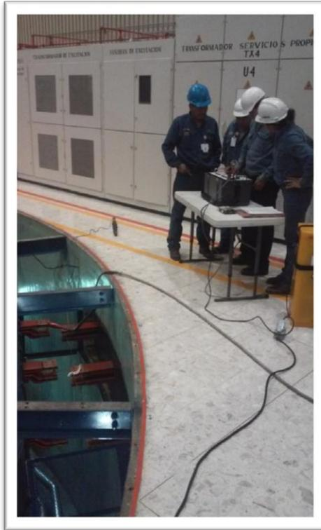
**FIG. C5 PRUEBA DE ALTA TENSION POR FASE AL GENERADOR**
