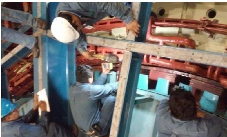
**Fig. 4.6** Prueba de Caída De Tensión a Polos
