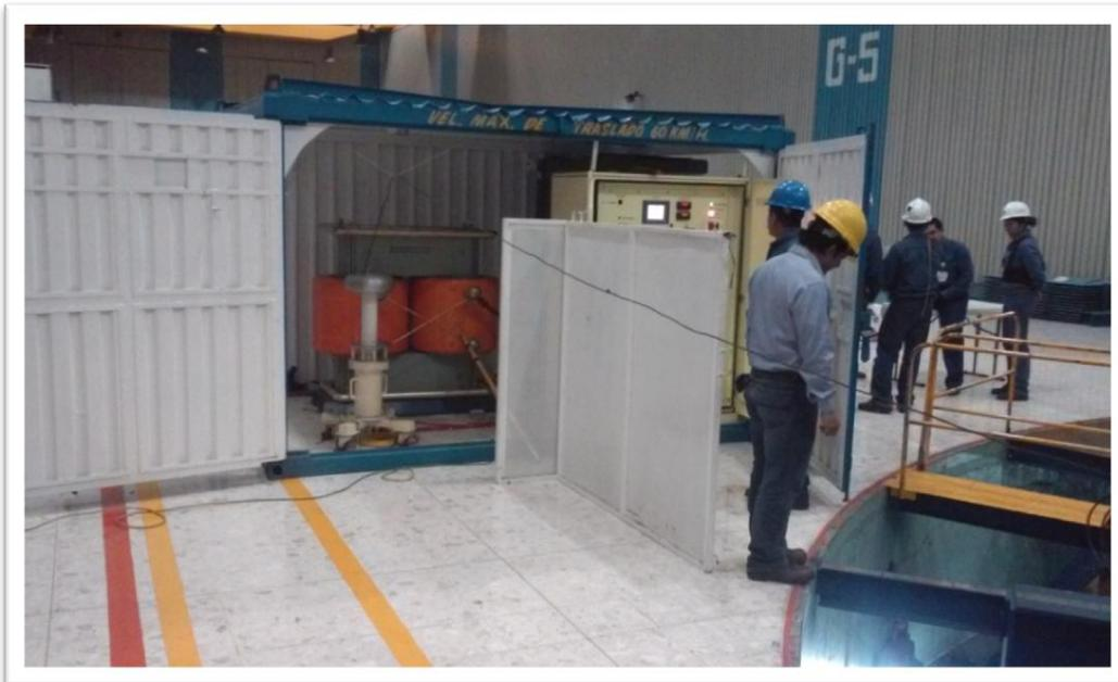
**FIG. C10** PRUEBA DE ALTA TENSION REALIZADO POR LAPEM
