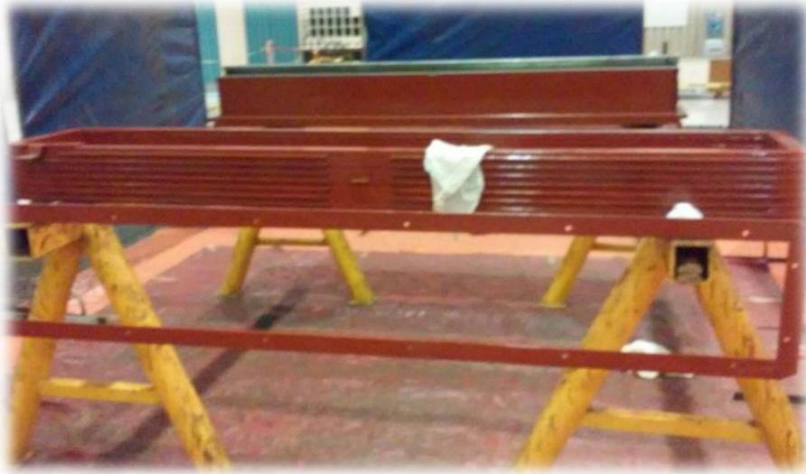
**Fig. 4.21** Núcleo, bobina y cuello después de la aplicación del barniz.
