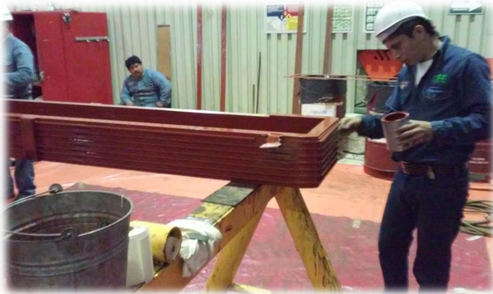
**Fig. 4.20** Aplicación del barniz en la bobina polar.
