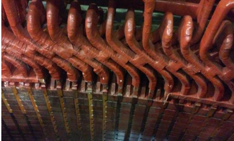
**Fig. 4.10** Bobinas después de Reparación
