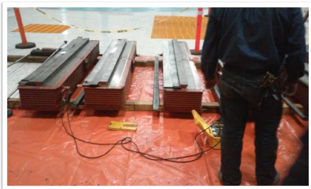
**FIG. C8** PRUEBA DE RESISTENCIA DE AISLAMIENTO A POLOS
