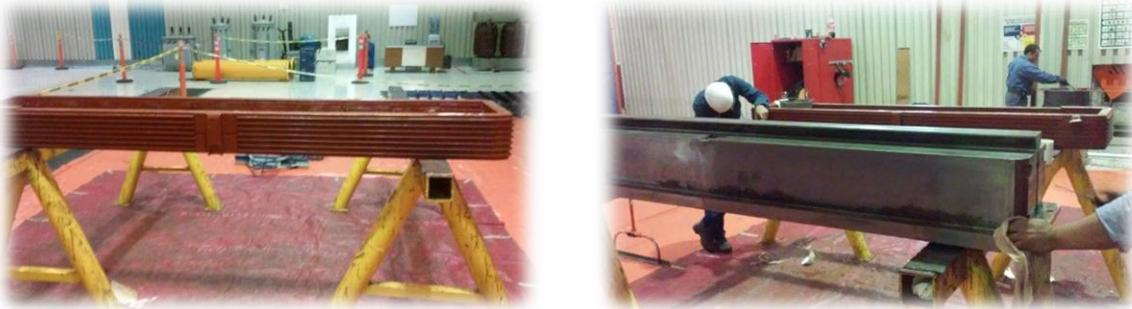
**Fig. 4.19** bobina polar y núcleo separados
