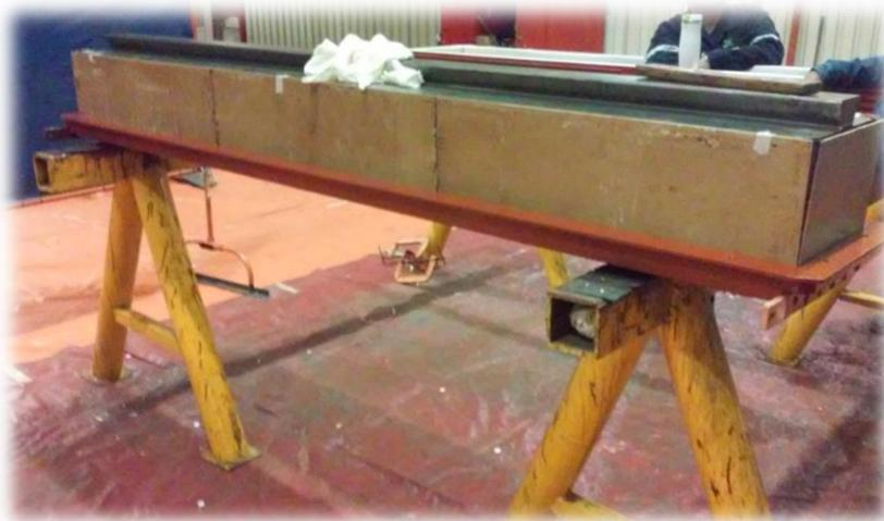
**Fig. 4.23** Aplicación de la baquelita al núcleo.
