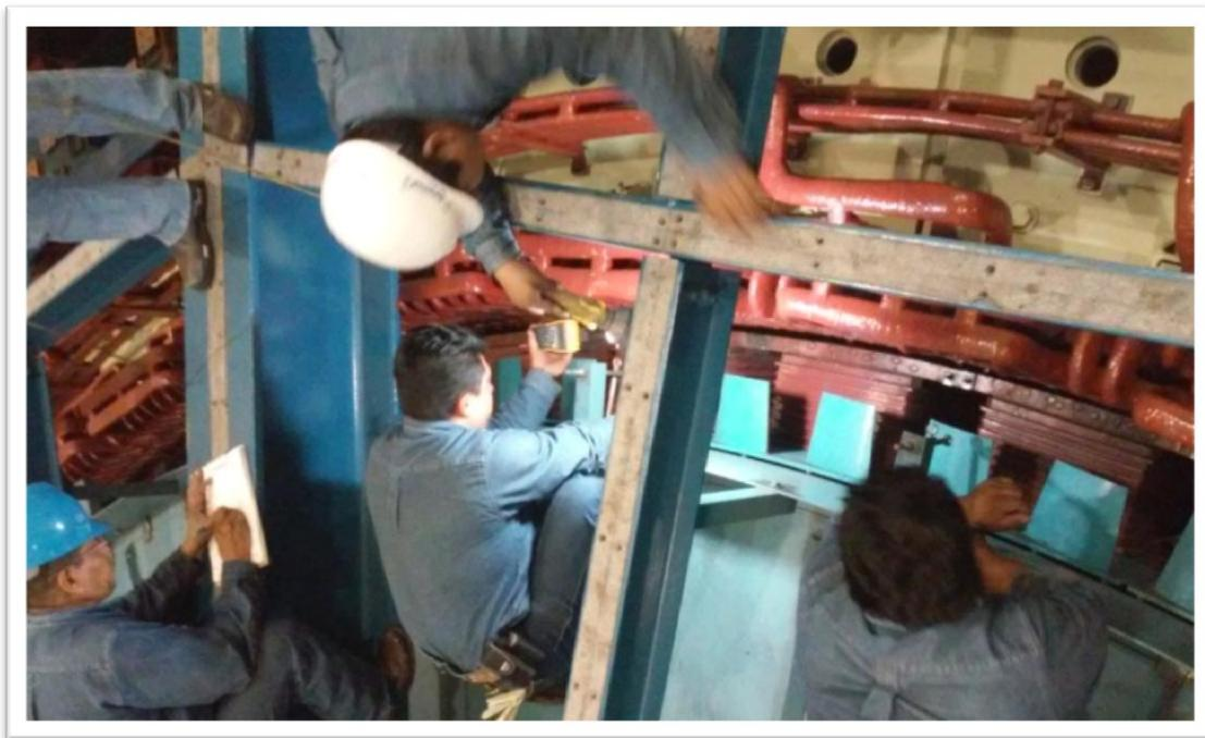
**FIG. C6 PRUEBA DE CAIDA DE TENSION A POLOS DEL ROTOR**
