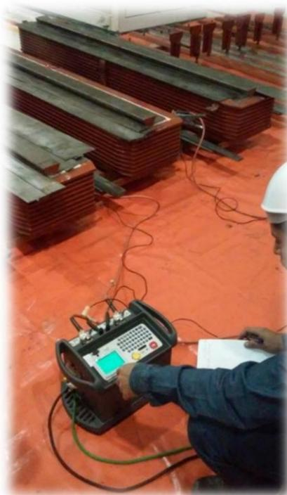
**Fig. 4.16** Medición de resistencia óhmica a polos
