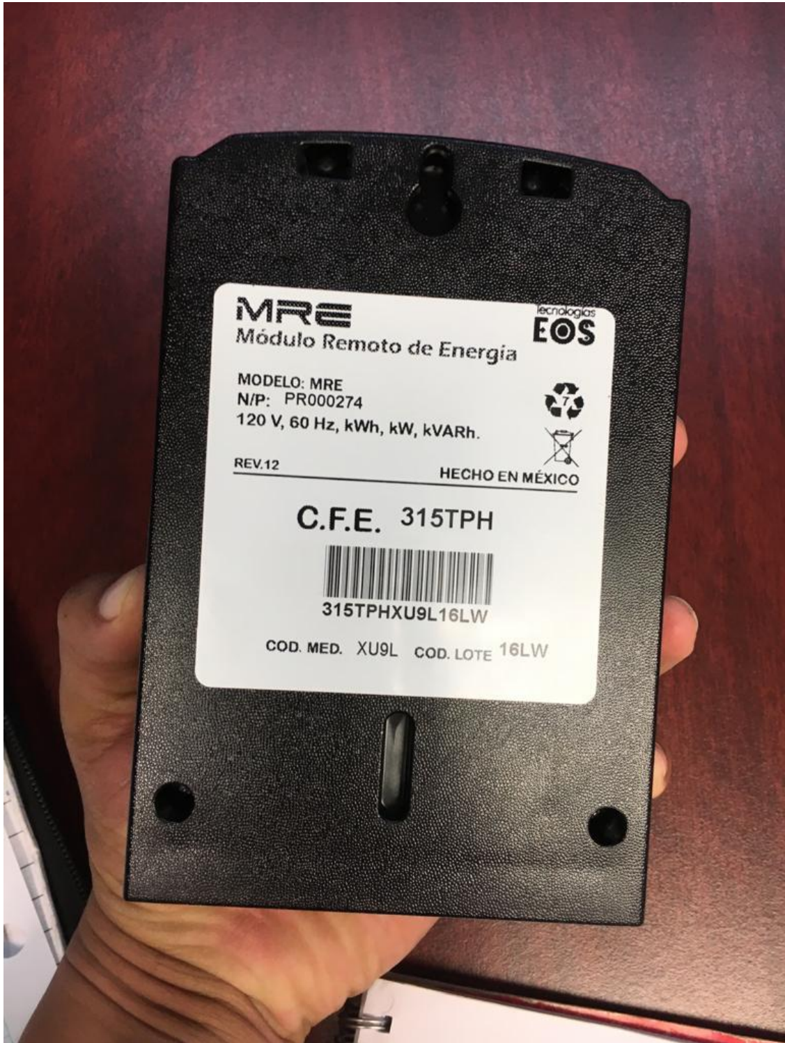
Figura 7.4. Módulo Remoto de Energía (parte de atrás).
