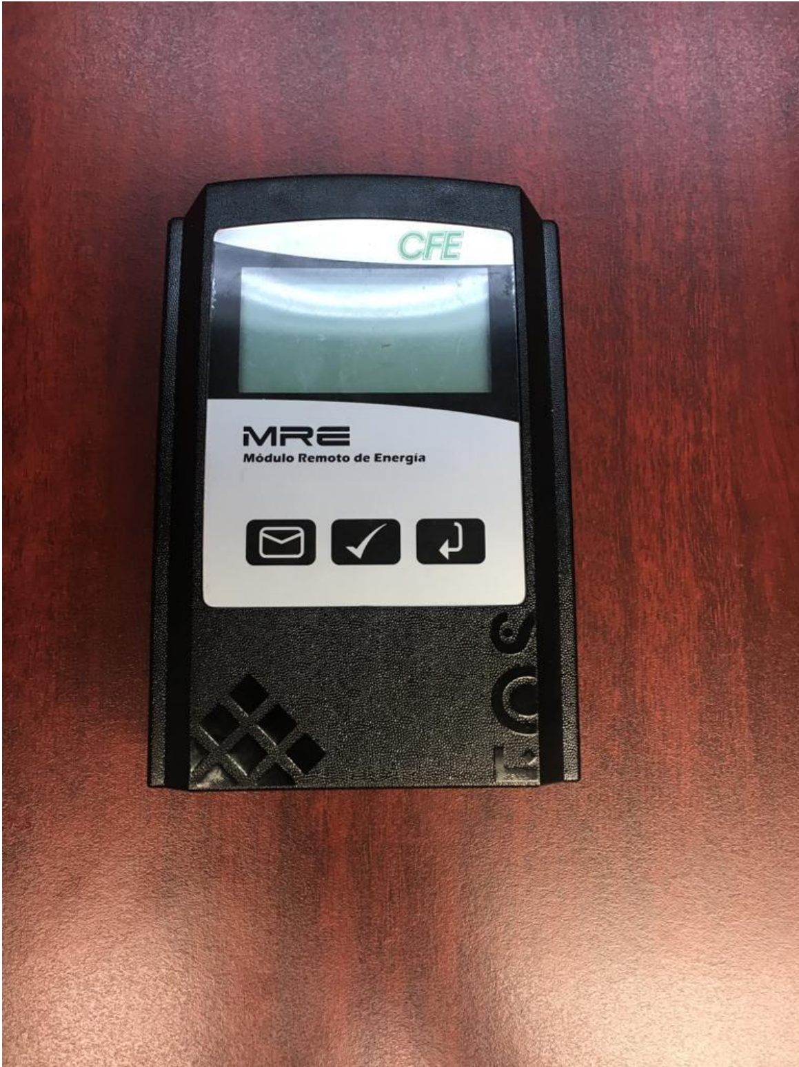
Figura 7.3. Módulo Remoto de Energía (parte de enfrente).
