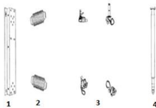
1-Base Metálica 2.-Aisladores Soporte 3.-Pates Vivas y de Conexión 4.- Porta Fusible y Elem. Fusible
