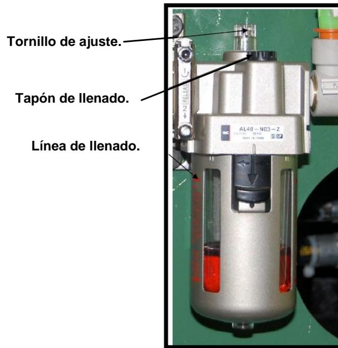
**Figura 5.7.- Lubricador de niebla.**
