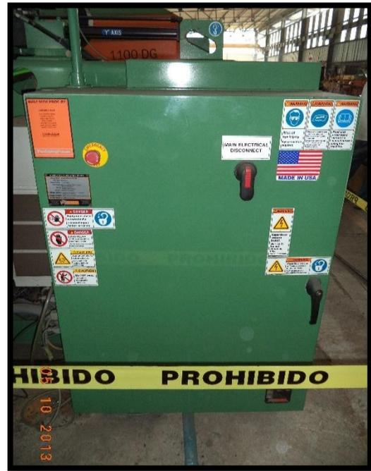
Figura. 2.2 Interruptor principal de desconexión.
