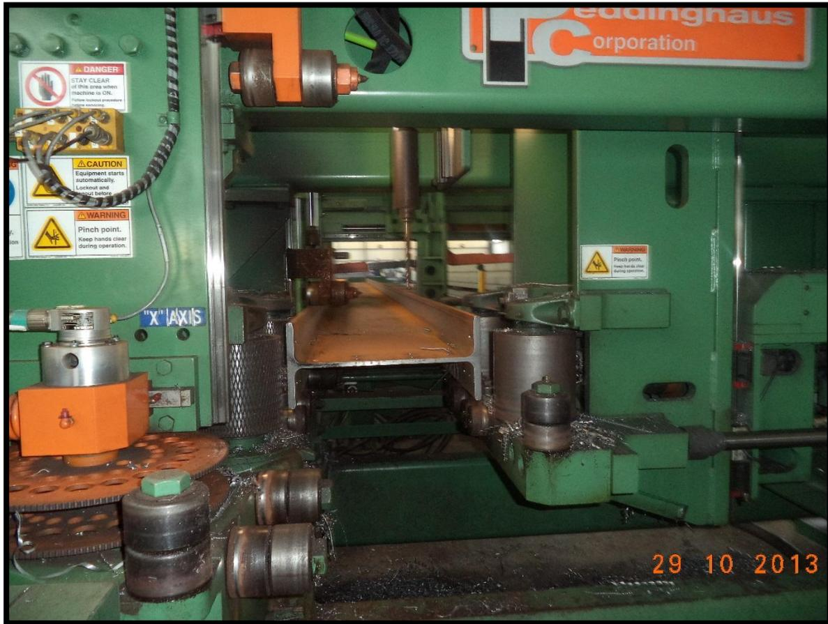
Figura 4.2. Procesamiento de vigas combadas.
