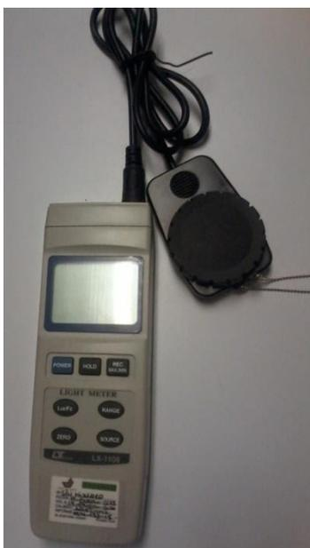
**Figura 3.** Equipo de medición de niveles de iluminación, luxómetro.
