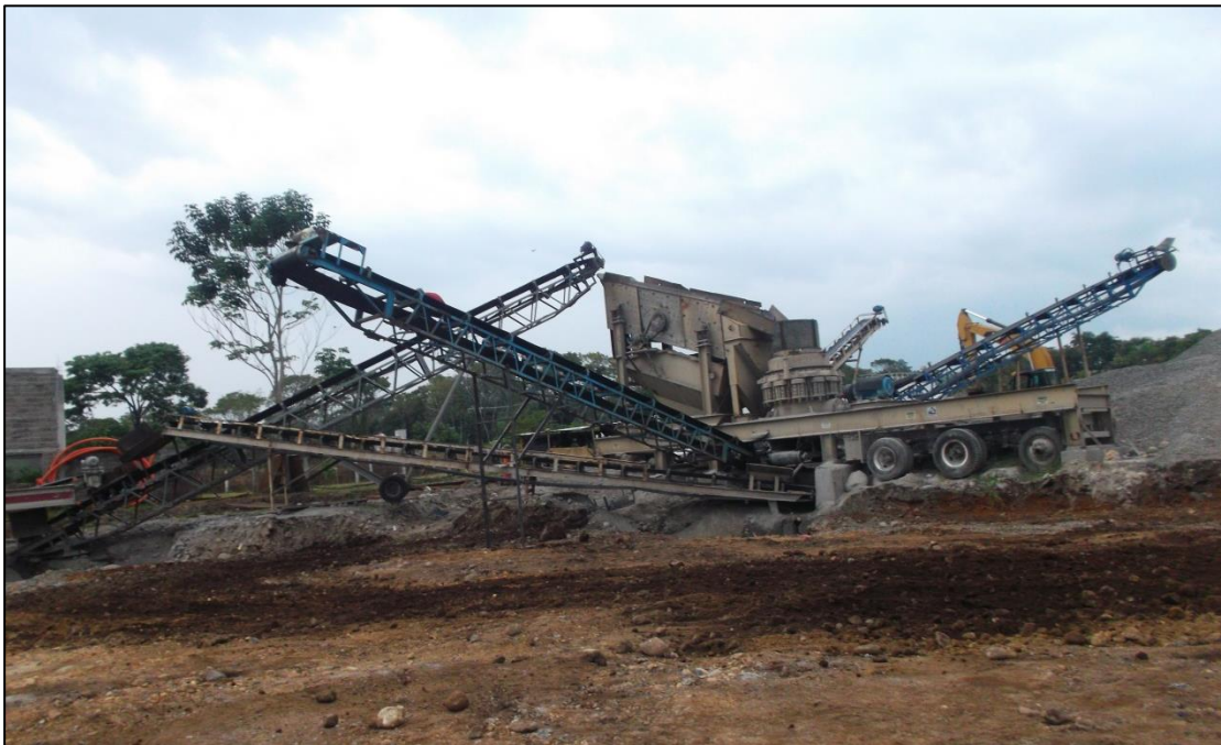
Fig. 4.3.- Planta Tapachula, en esta planta se producen triturados como Arena, Grava de \frac{3}{4} y de \frac{1}{2} , Sello, entre otros.
