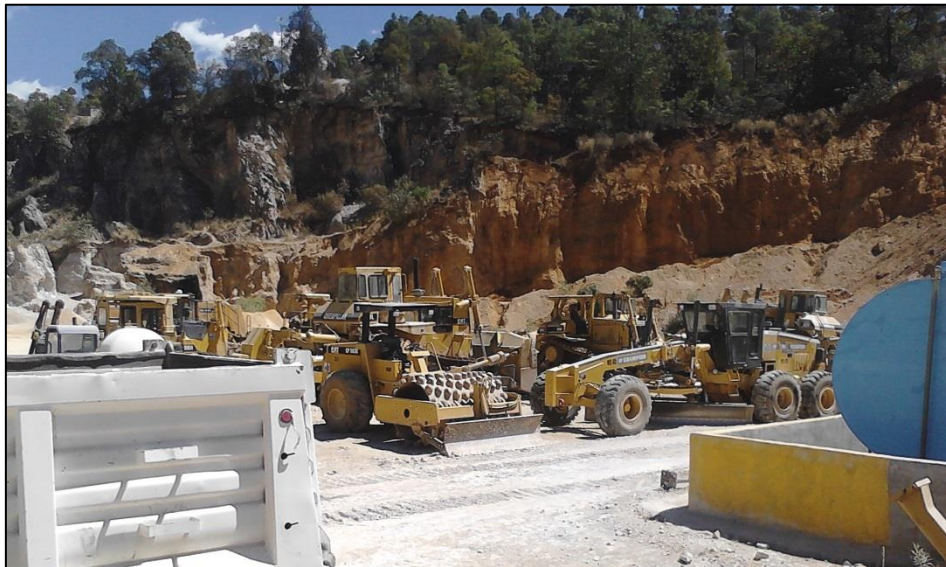
Fig. 4.4.- En esta imagen se puede observar máquinas para corte y nivelado de caminos, como pueden ser tractores y motoconformadoras, éstas ubicadas en planta San Cristóbal.
