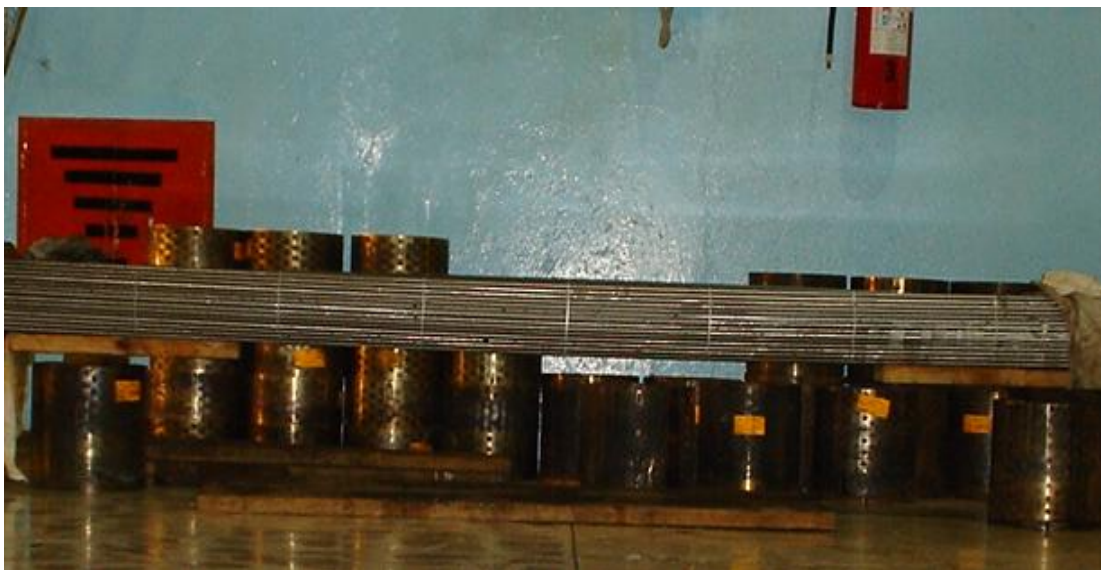
Imagen 1.4 Haz de tubos del intercambiador de calor de la chumacera combinada de las unidades de la segunda etapa.
