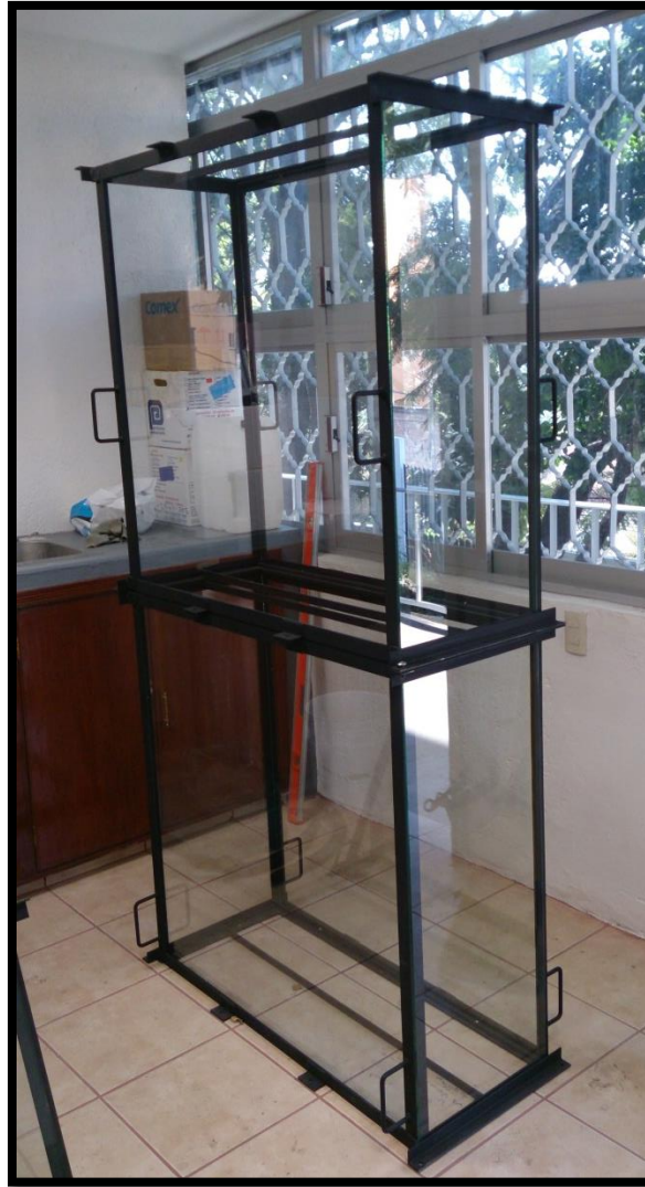
Figura 11. Módulos inferiores de la chimenea solar.
