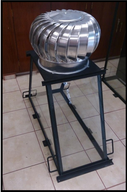
Figura 16. Módulo superior con el extractor de aire montado.
