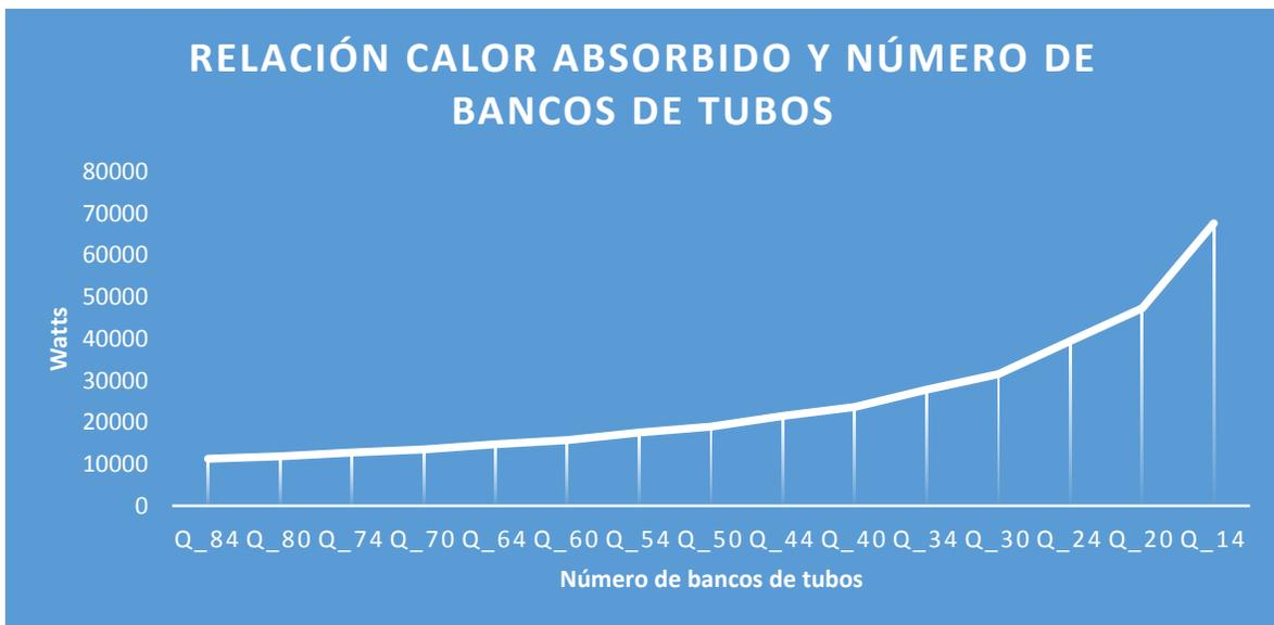
Fig. 3.6 Gráfica de la relación existente entre el calor absorbido por los bancos de tubos.
