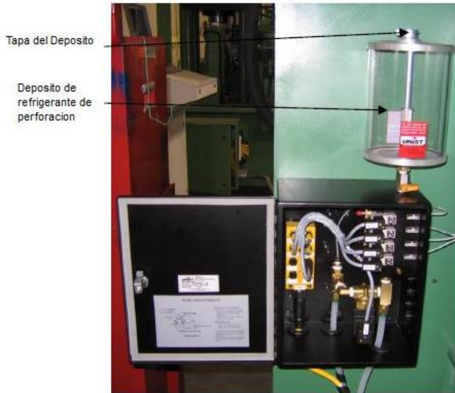
Fig. No. 10 Depósito de refrigerante de perforación
