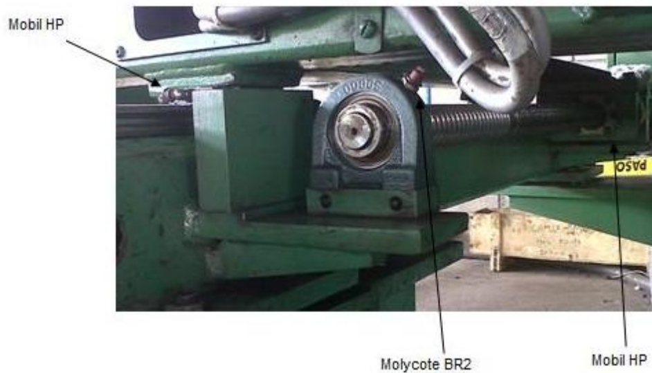
Fig. No. 15 Puntos de lubricación del punzón.
