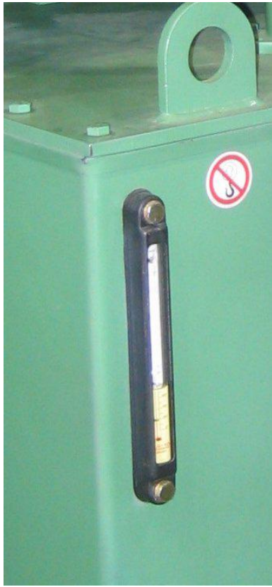
Fig. No. 7 Medidor de nivel y temperatura de fluido hidráulico.
