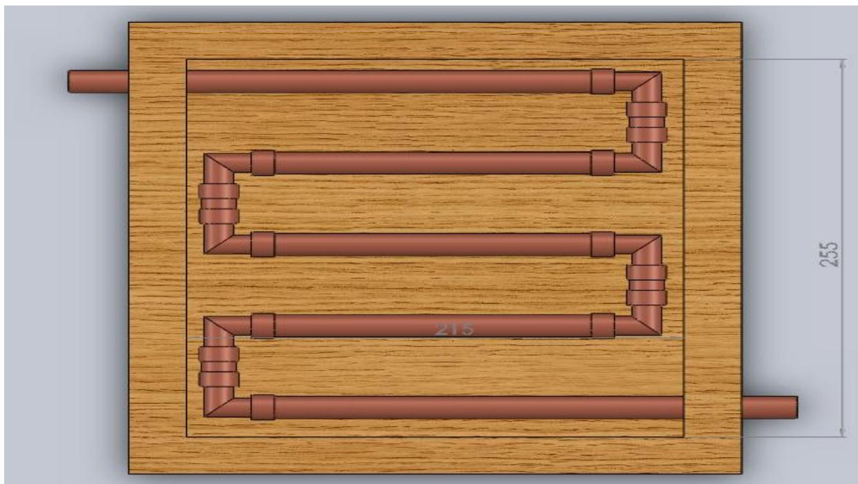
Figura D1: Caja térmica y en su interior serpentín de tubos de cobre
