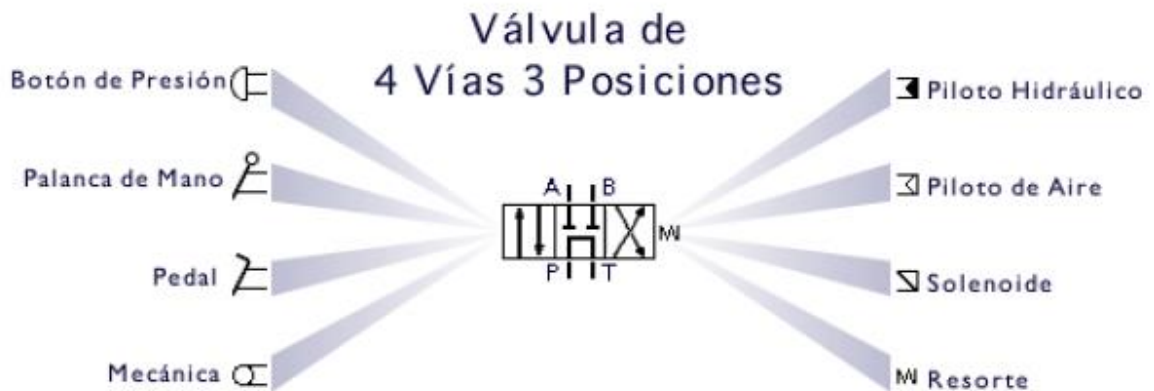
Fig.21 Símbolo de los distintos accionadores de una válvula direccional
