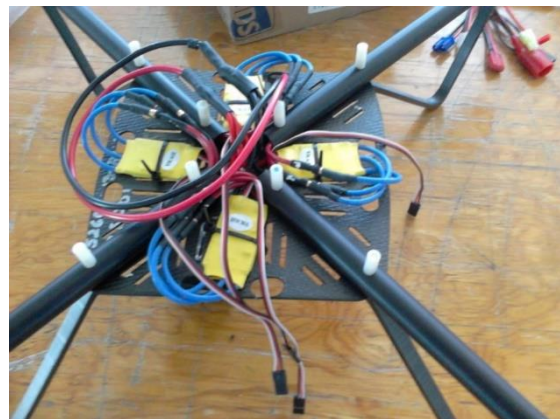
Figura [6.8] Colocados los ESC a sus lugares
