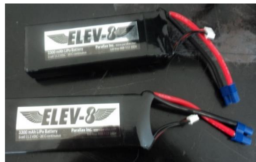
Figura [4.18]: Baterías lipo
