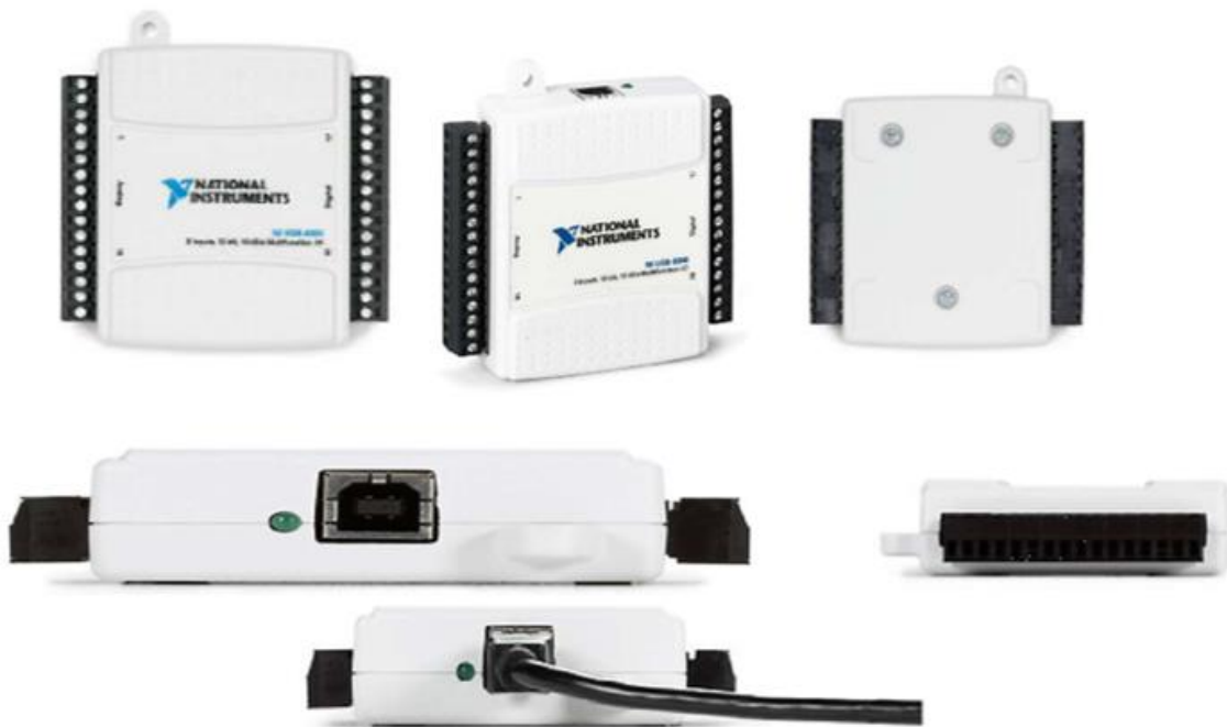
Figura 4.3 Tarjeta de adquisición de datos NIDAQ 6008 de National Instruments.
