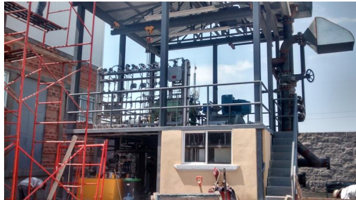
Fig. 9 Banco de pruebas de compresores centrífugos a escala real.
