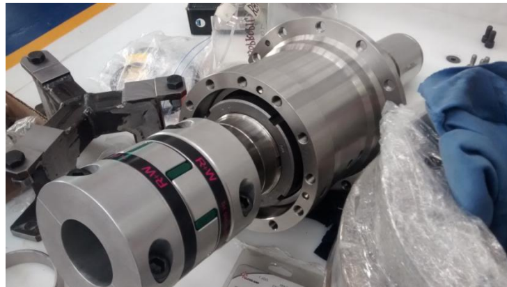
Fig. 39 Espaciador de acoplamiento y tuerca de retención.
