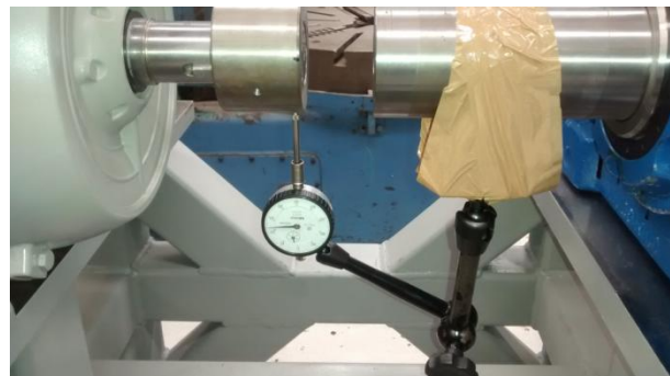
Fig. 28 Alineación vertical motor + transmisión.
