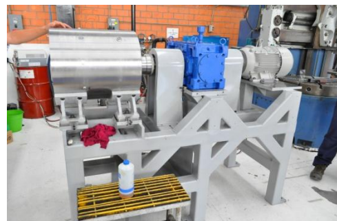
Fig. 11 Banco de pruebas de sellos de turbomaquinaria para producción.
