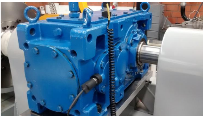
Fig. 57 Posición de los sensores del colector de datos.
