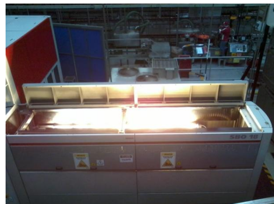
Fig. 5.- Vista superior del horno el cual calienta las preformas mediante unas lámparas infrarrojas.
