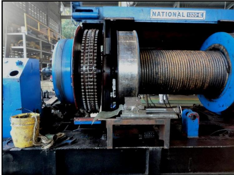
articulaciones, cinchos (fig. 8.9) y Fig.8.9. Lebus sin el cincho de balatas freno de la corona (crown-o-matic) con cuidado para no deformar los cinchos.
