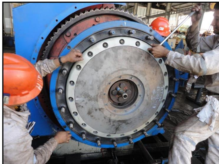
Fig.8.14.Instalación de embrague de baja
