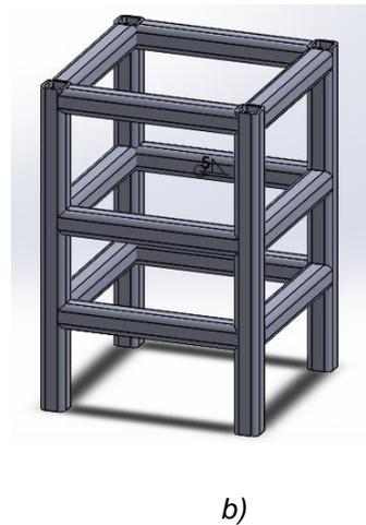
Figura 4.11 Perfiles de la estructura de la máquina, a) perfiles cuadrados verticales b) perfiles horizontales unidos a los verticales.
