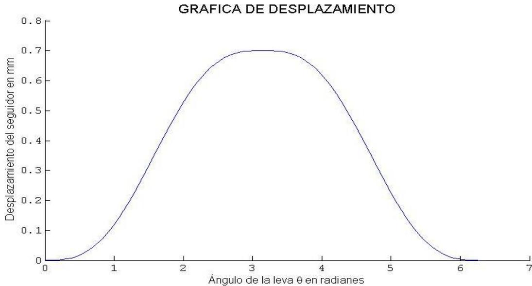
Figura 3.5. Gráfica de desplazamiento del seguidor de la leva
