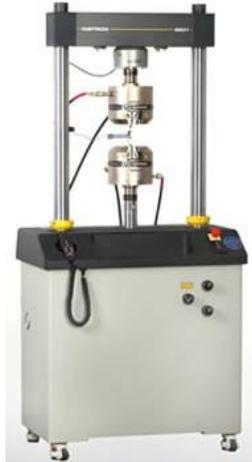
*Figura 1.9. Máquina de Ensayo de Fatiga Axial*
