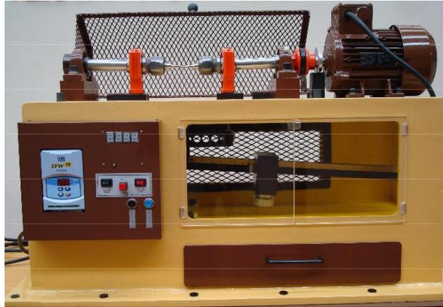
*Figura 1.7. Máquina de fatiga de flexión rotativa.*
