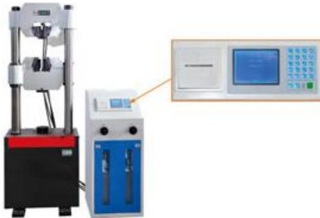
*Figura 1.8. Máquina universal de ensayos hidráulica*
