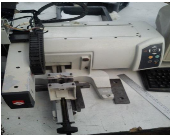
Maquina gravograph realizando el grabado del número de parte de la pieza
