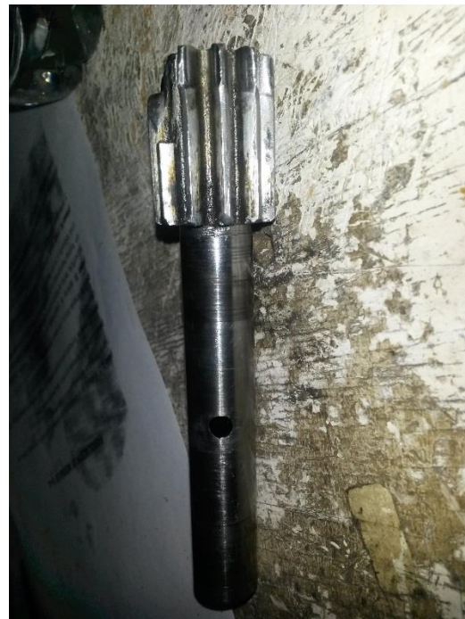
Cambio de engrane del carro principal
