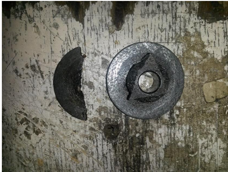
Carrete de engrane dañado y reemplazado
