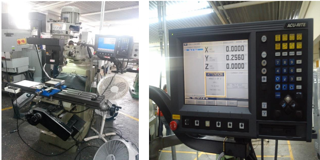
Fig. 4.10.1 Fresadora CNC y Pantalla de control de Plastimaq
