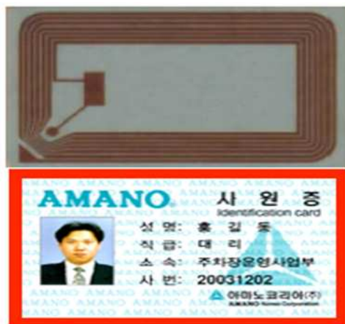
Figura 2.5: Ejemplo de cobertura de un tag RFID
