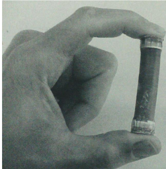
Figura 3. Rollo Electroelastómero Multifuncional (MER). (Imagen de SRI).
