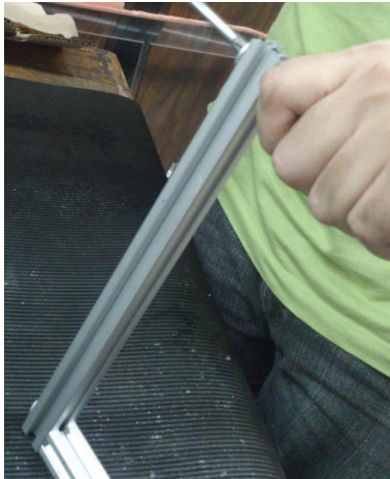
Figura 27. En esta imagen se atornillan las barras estructurales.
