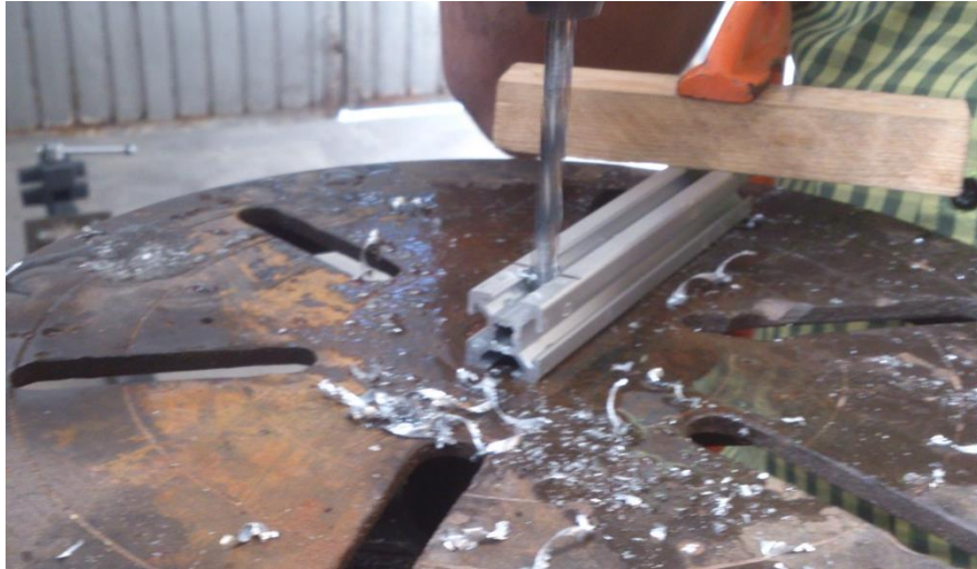
Figura 23. Ultima barra perforada.
