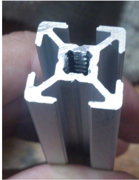
Figura 31. Vista de la barra estructural después de atornillarla.
