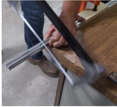
Figura 16. Cortando la barra estructural de aluminio para obtener una pieza de 14 cm.
