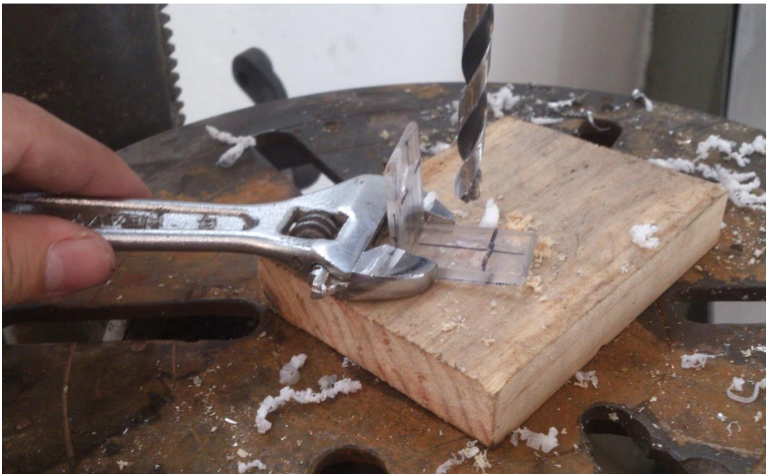
Figura 24. En esta imagen se acomoda el perfil en "L" en el lugar donde es preciso abrir un agujero.
