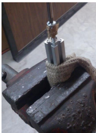
Figura 30. Realizando una rosca a la barra estructural de aluminio.
