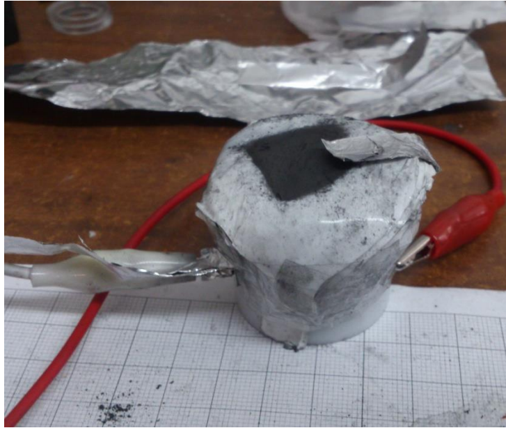
Figura 61. Configuración en multicapa de la silicona Dow Corning f109.
