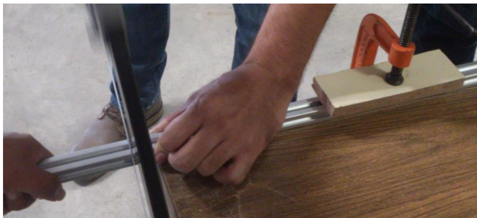
Figura 18. Corte de la estructura de aluminio para generar una pieza de 29 cm.
