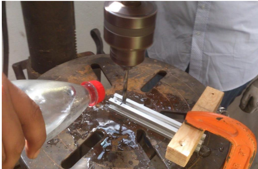
Figura 22. Proceso de taladrado de la barra estructural de aluminio (se arroja un poco de agua para que no se caliente el material).
