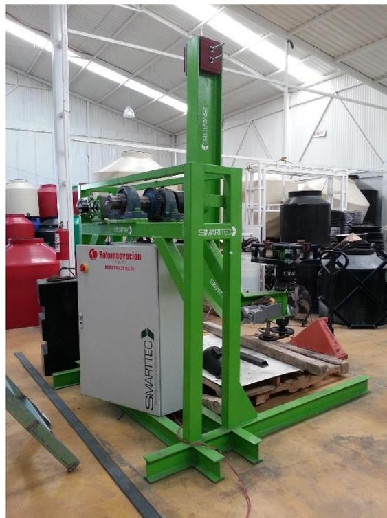
Figura 43: Máquina de rotomoldeo en etapa de diseño en terminación
