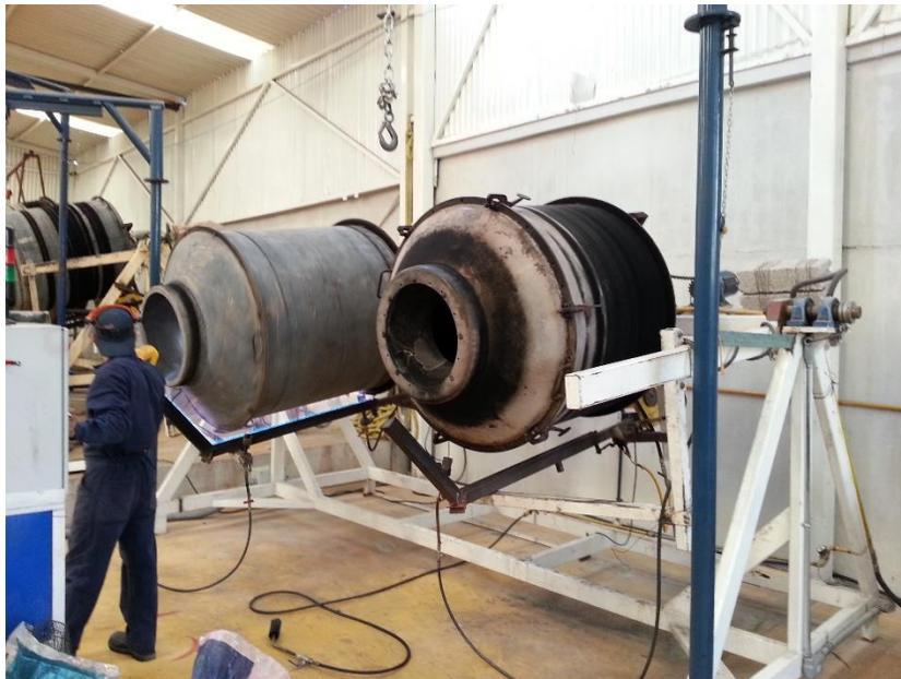
Figura 41: Maquina de rotomoldeo para tinacos con capacidad de 750 litros.
