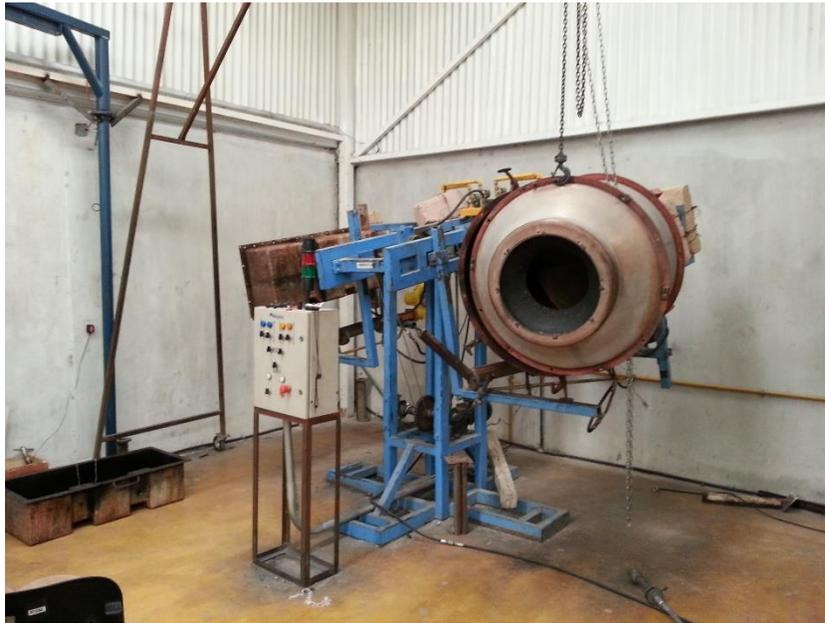
Figura 40: Maquina de rotomoldeo para tinacos con capacidad de 120 y 450 litros.
