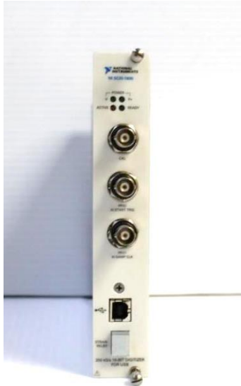
Figura 3.5. NI SCXI – 1600. Módulo de control y adquisición de datos
