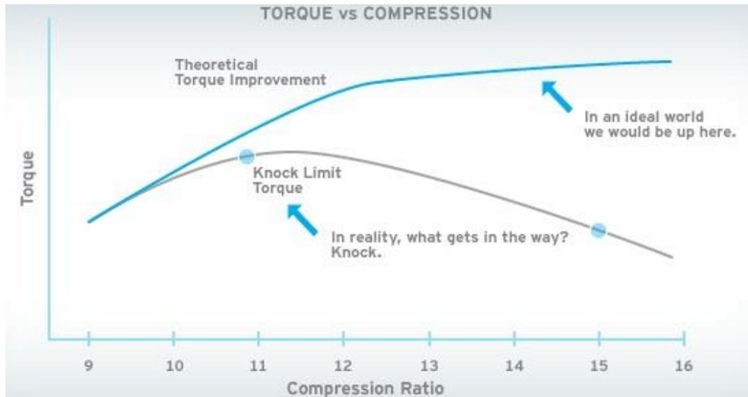
Ilustración 2. Se muestra la gráfica de comportamiento teórico e ideal de la relación de compresión del combustible respecto al torque que otorga.<sup>1</sup>
