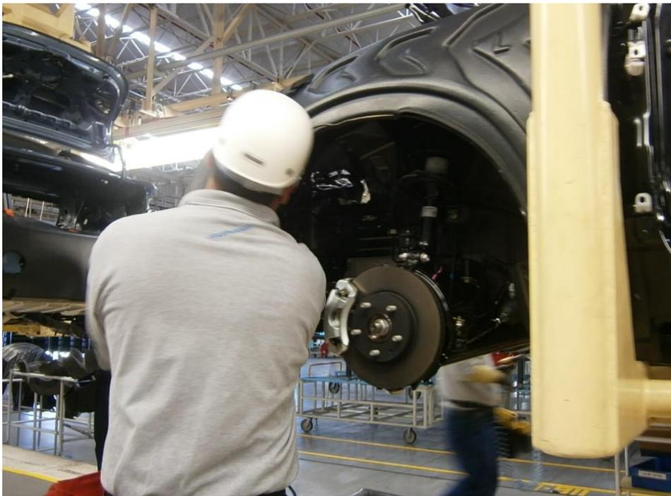
*Ilustración 26. Operación de aseguramiento de fascia y rechequeo de tubería de freno.*
