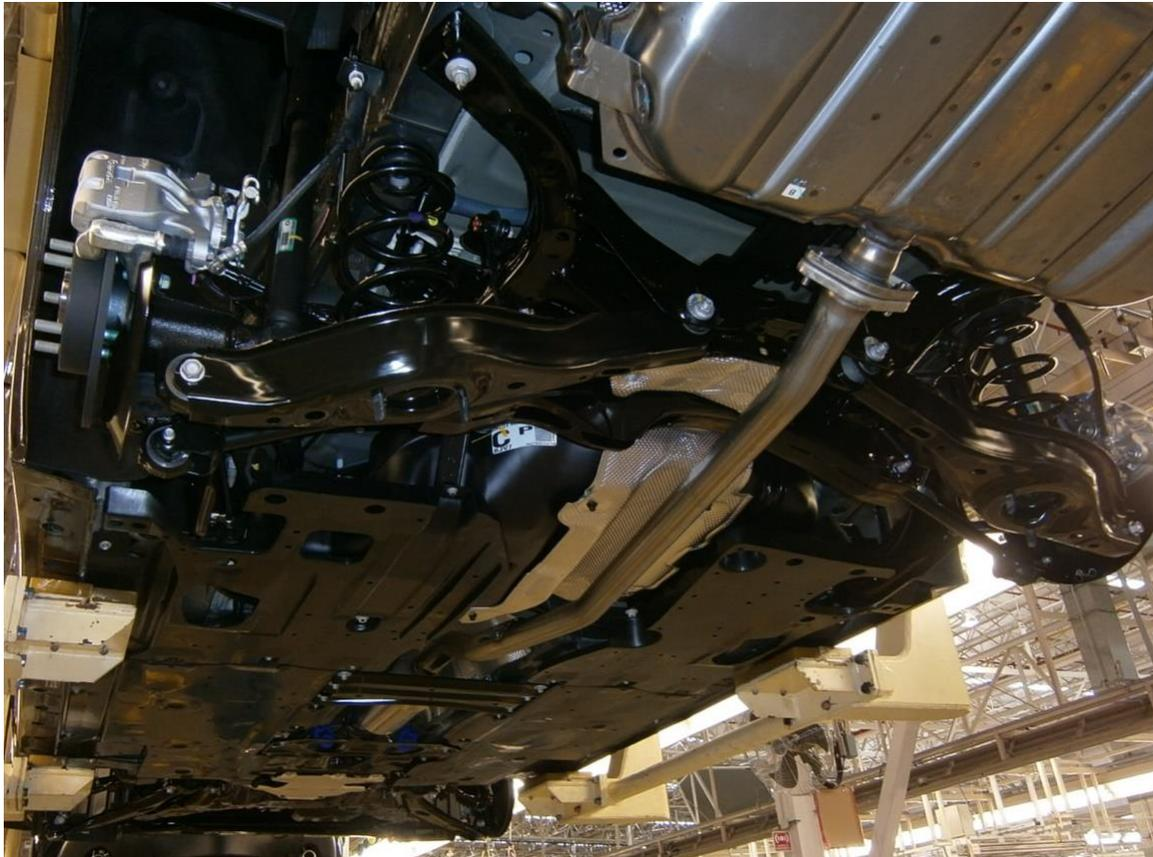
*Ilustración 25. Unidad ensamblada bajo piso lista para pasar al área de Línea final.*
