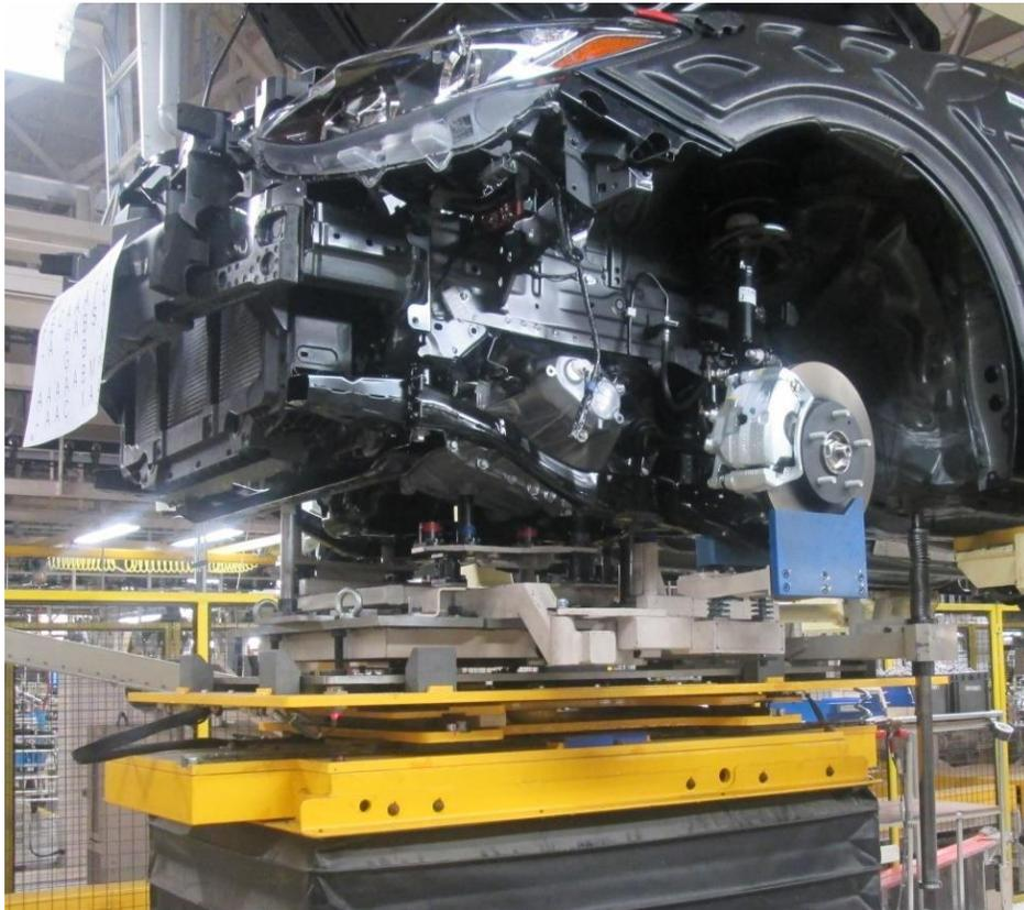
Ilustración 22. Casamiento de motor a carrocería.
