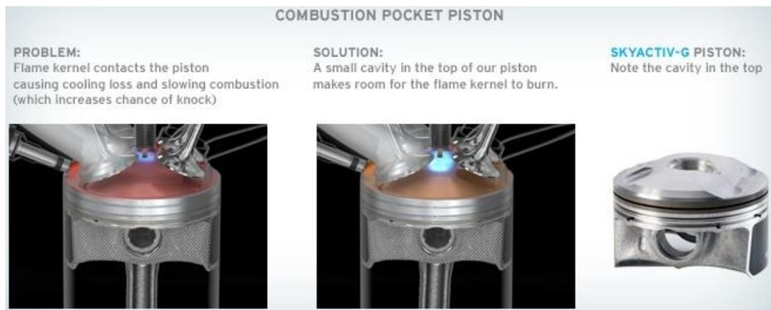
Ilustración 3. Pistón modificado para el motor Skyactiv, con una cúpula que ayuda para lograr las altas relaciones de compresión y las cavidades a estabilizar la combustión.<sup>2</sup>
