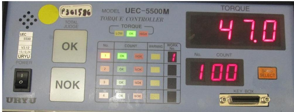
Ilustración 59. Dispositivo marca Uryu, utilizado principalmente para herramientas neumáticas.
