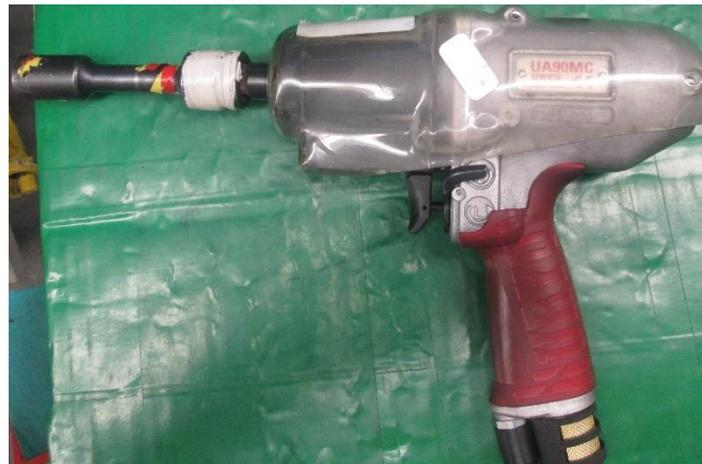
Ilustración 60. Herramienta neumática (UA90MC).
