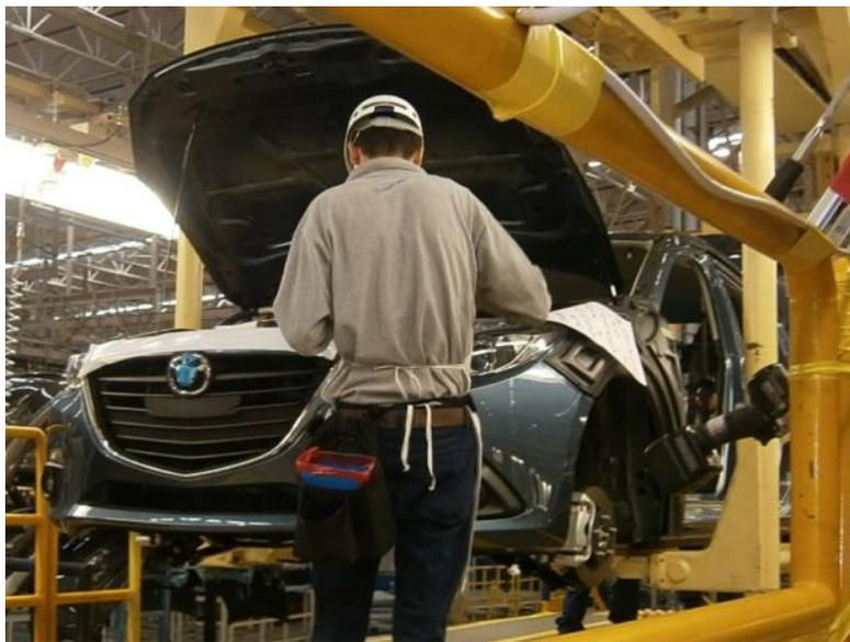
Ilustración 24. Colocación y aseguramiento de fascia.
