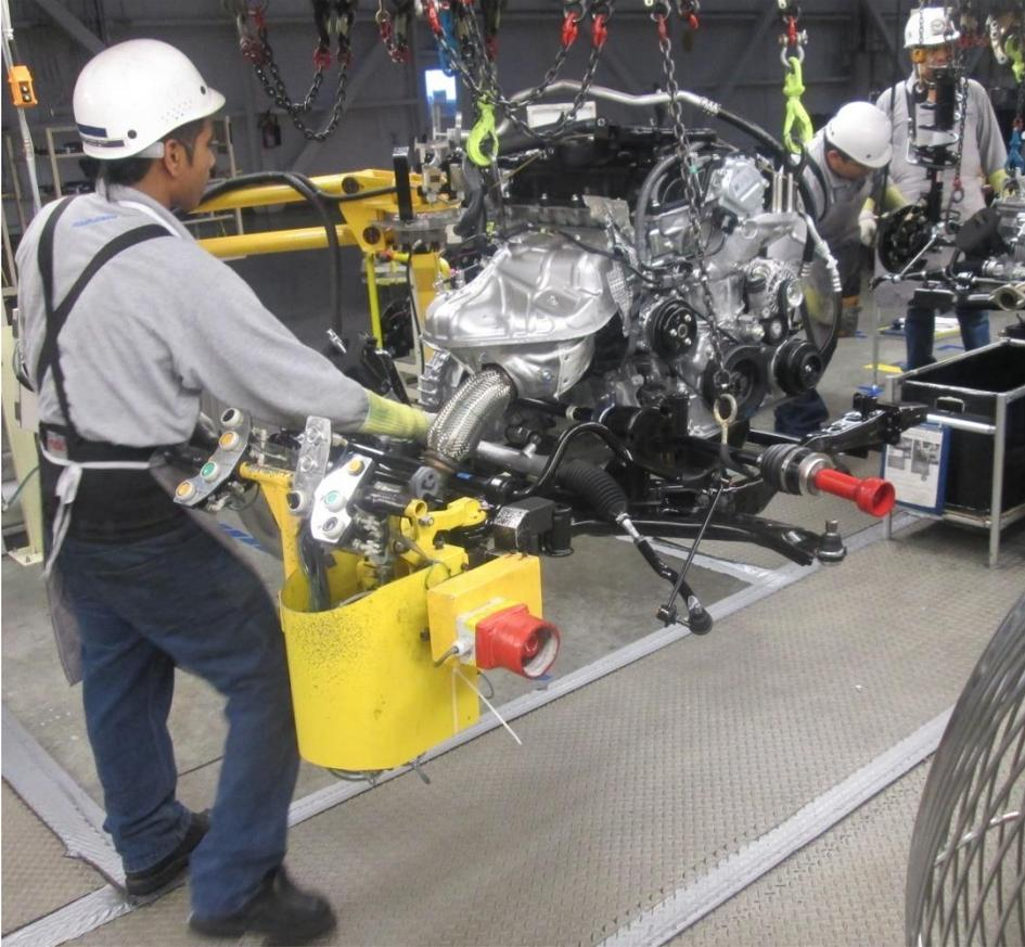
*Ilustración 29. Casamiento de suspensión delantera a motor.*
