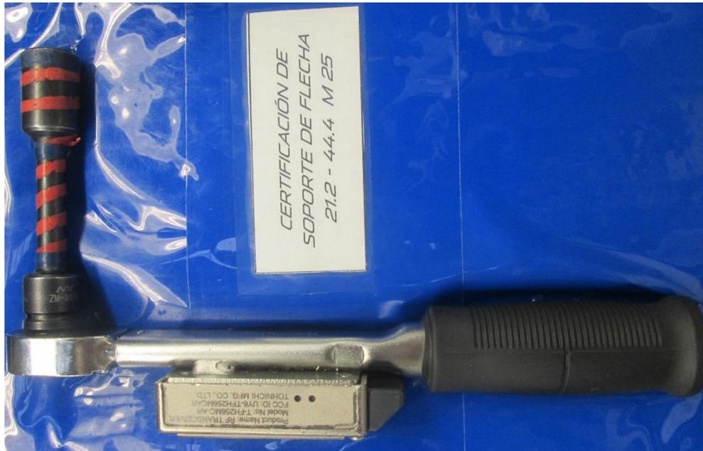
Ilustración 57. Torquímetro inalámbrico utilizado en dispositivos Atlas.
