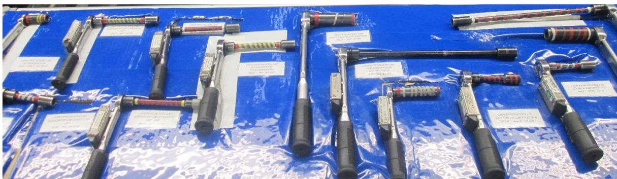
Ilustración 58. Torquímetros utilizados en la zona de motores, estaciones 25 y 26.
