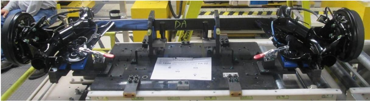
Ilustración 33. Suspensión trasera modelo J03W.
