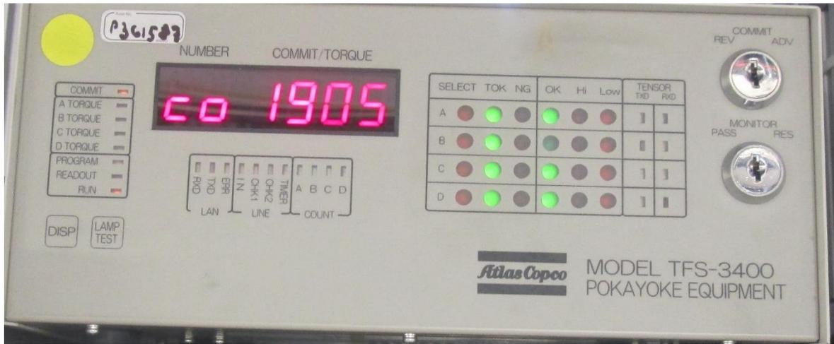
Ilustración 56. Controlador Atlas Copco utilizado para torquímetros con antena inalámbrica.
