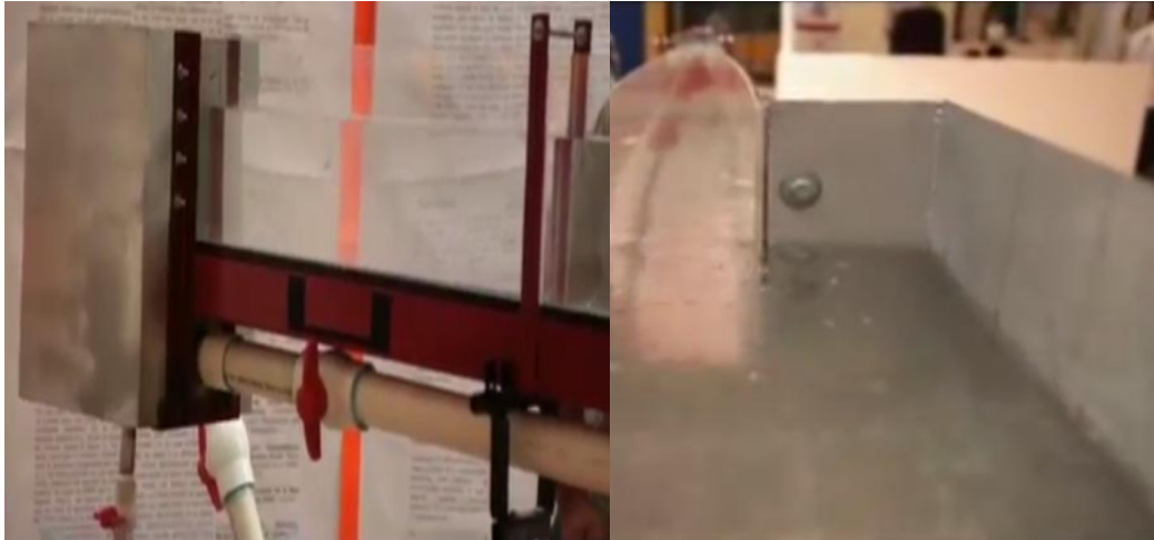
Figura A.2.3 Tanque disipador de energia del agua del sistema
