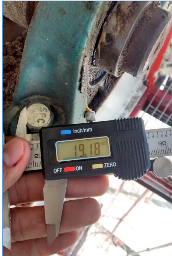
Figura 4.6.- Toma de medida de una chumacera de piso.
