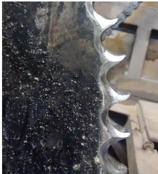
Figura 2.3.- Rueda dentada con excesivo desgaste, provoca tiempos muertos debido a la falta de cambio al final de su vida útil.
