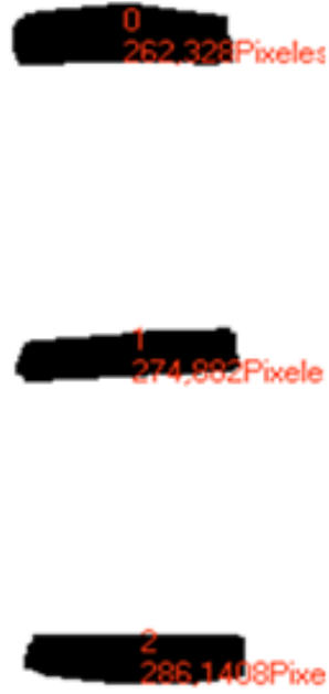
Figura 41 Imagen procesada donde se aprecian las coordenadas en píxeles de los centroides en cada marca
