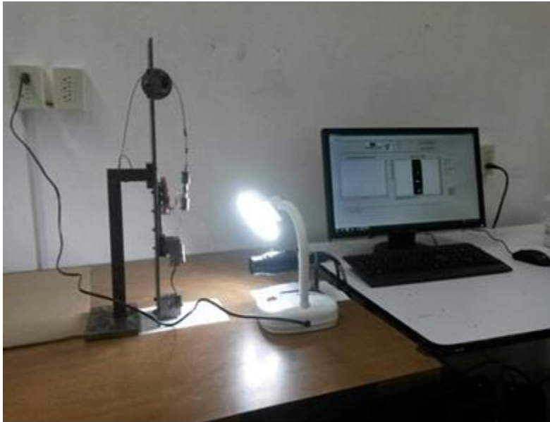
Figura 40 Sistema de visión por computadora para video extensómetro implementado con LabView.
