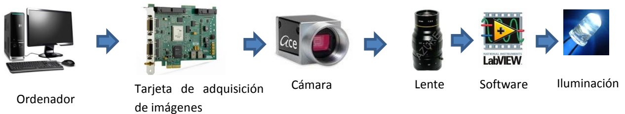
Figura 9 Proceso básico en un sistema de visión
