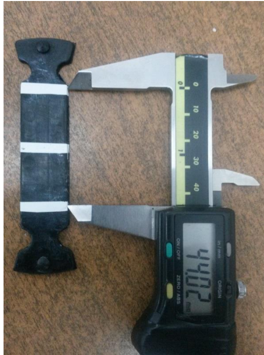
Figura 2. Probeta con marcas de referencia a distancias conocidas.
