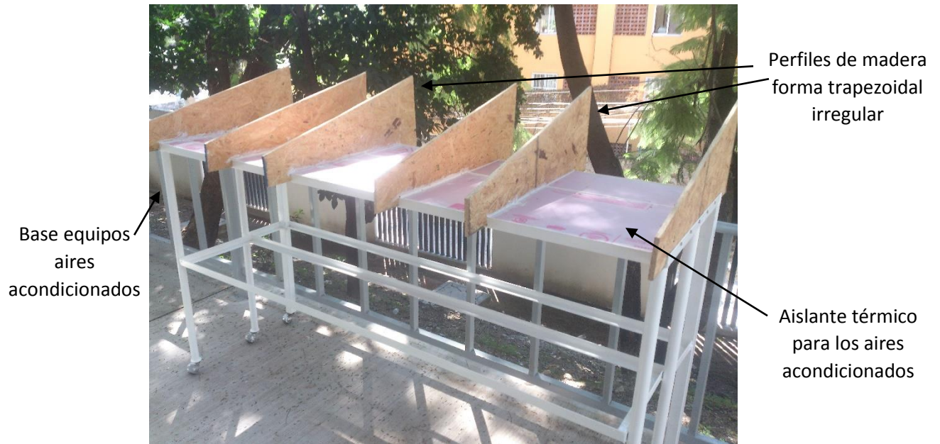
Figura 76. Base equipos de aire acondicionado con perfiles de madera trapezoidal irregular
