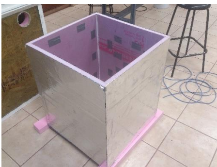
Figura 70. Envoltente con láminas delgadas de aluminio para evitar variantes altas de temperatura
