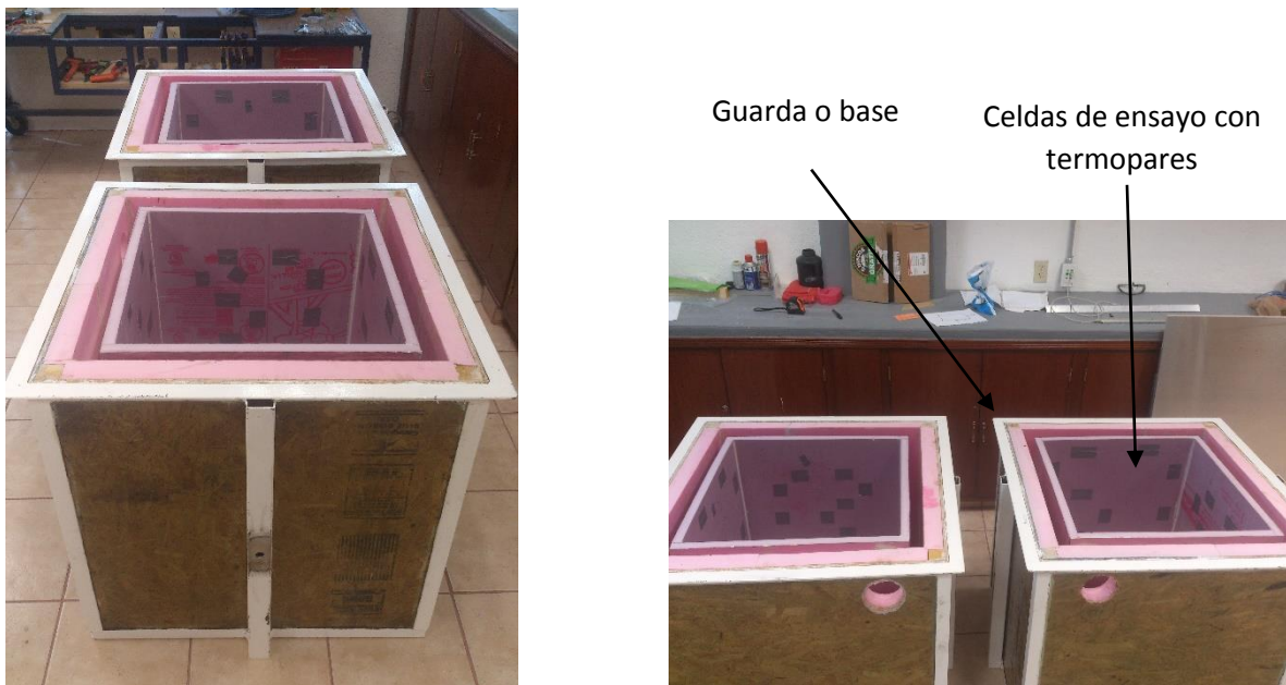
Figura 75. Montaje celdas de ensayo con termopares y guarda o base
