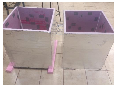
Figura 70. Envoltente con láminas delgadas de aluminio para evitar variantes altas de temperatura
