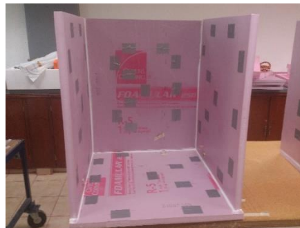
Figura 69. Unión de las paredes y techos de espuma de poliestireno con Termopares de las celdas
