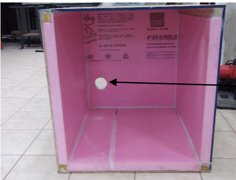
Figura 72. Anexo de los aislantes térmicos a las bases principales de madera de las guardas.
