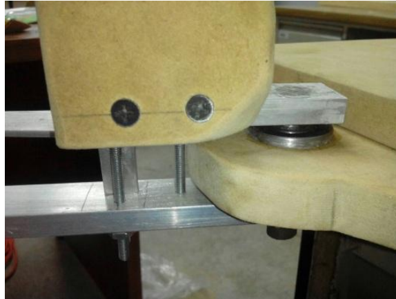
Figura 8.22. Soporte de la mano y eje, colocados
