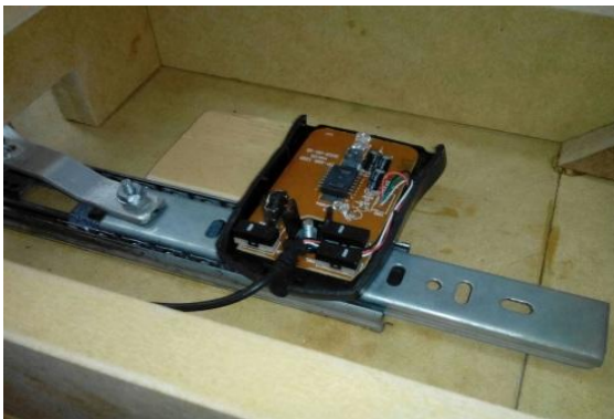
Figura 8.20. Corredera con el mouse óptico
