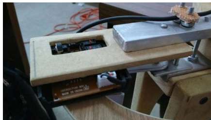
Figura 8.24. Madera adaptada para el mouse.
