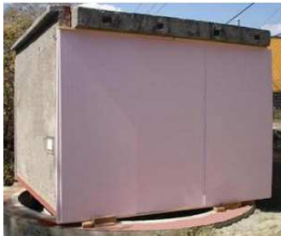
Figura 3.1 Caseta Giratoria para Estudios Térmicos de Viviendas (CAGETEV)
