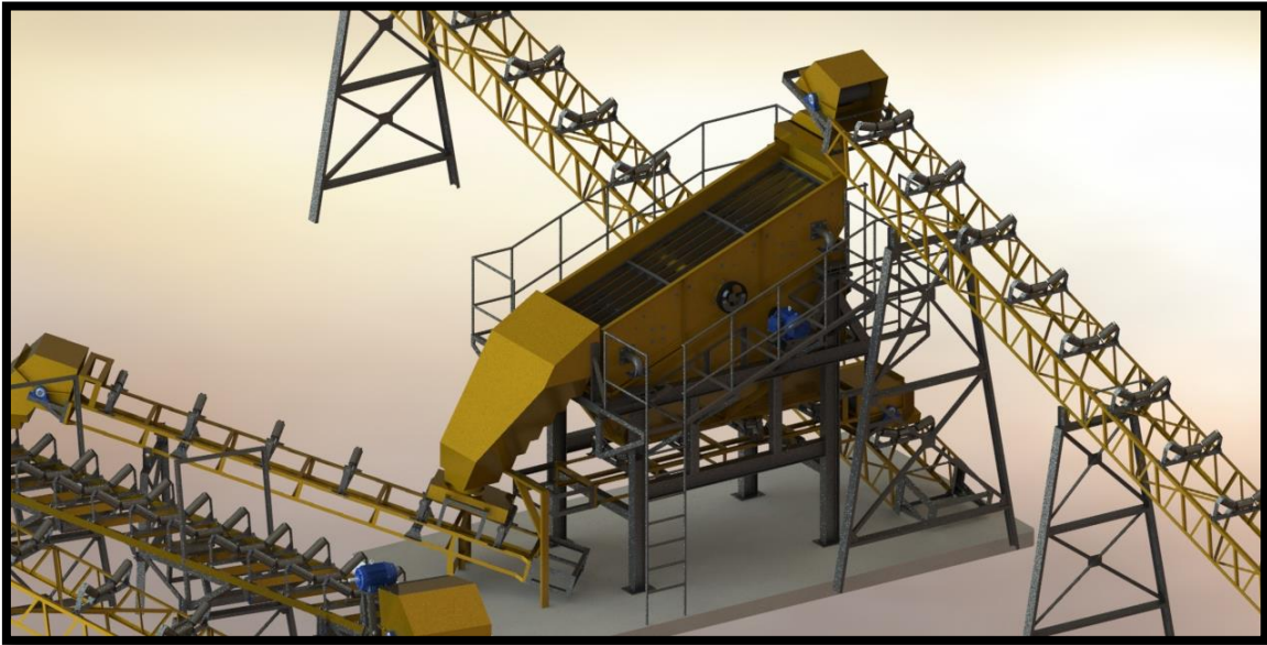
Fig. 5.2 Criba vibratoria y sus elementos.
