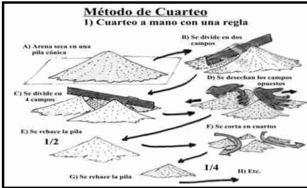
Fig. 3.28. Método de cuarteo.
