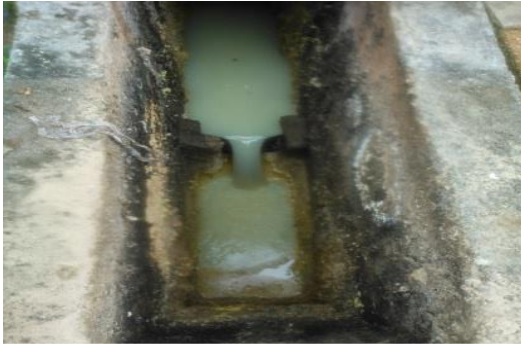
Fig. 5.4. Caudal medido con un vertedor tipo triangular, usado como gasto de diseño.
