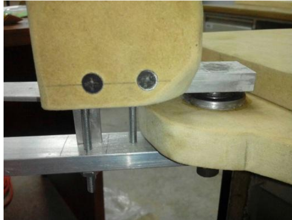
Figura 8.22. Soporte de la mano y eje, colocados
