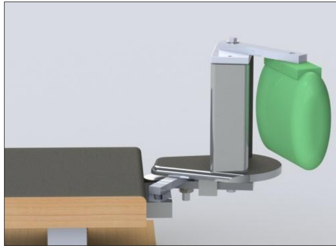
Figura 8.12. Dispositivo rehabilitador. Base, y soporte de los dedos y la mano
