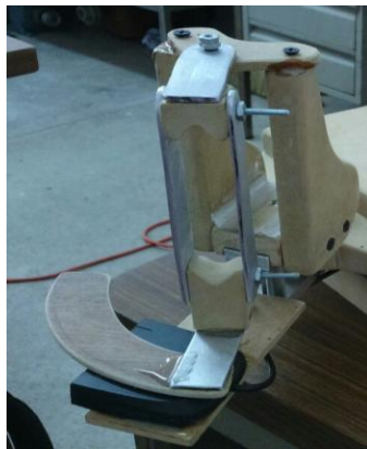
Figura 8.23. Mecanismo para el segundo mouse (Movimiento de los dedos)
