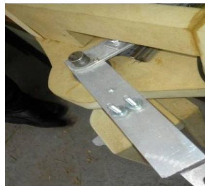
Figura 8.21. Eje de transmisión del movimiento
