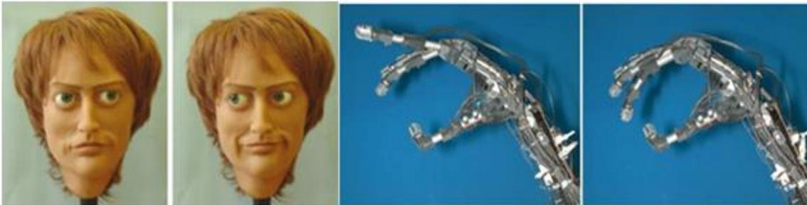
Fig. 7.6 Rostro con movimientos faciales y mano robótica elaborados por EAP's.
