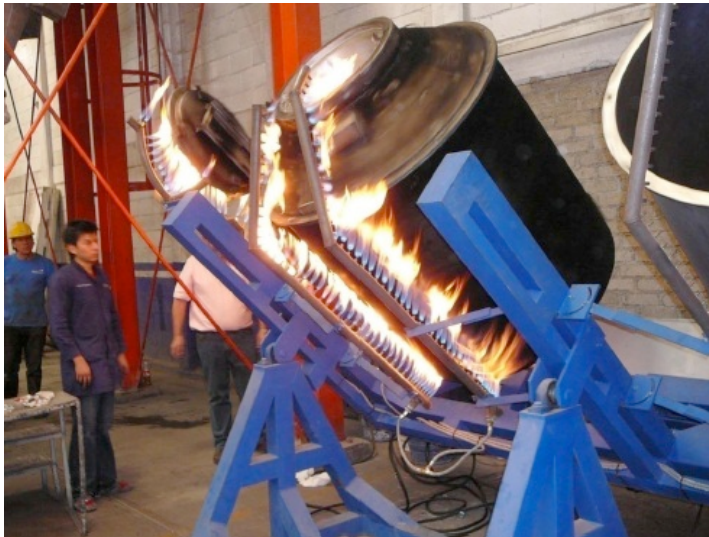
Figura 2.4: sistema de flama abierta [5]
