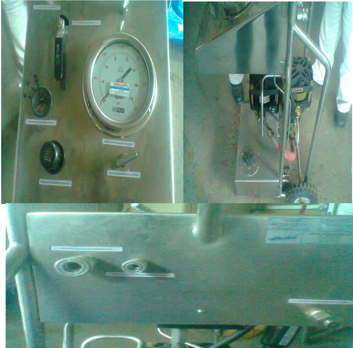
Fig.15 Banco de pruebas hidráulico para válvulas de alivio del taller del mantenimiento mecánico.
