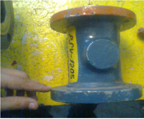
Fig.24 Bonete de la válvula de seguridad
