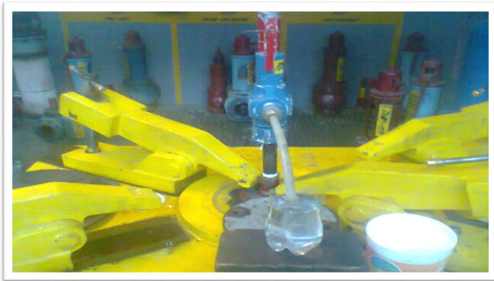
Fig.3 Banco de prueba del laboratorio de calibración de válvulas (Válvula de seguridad)
