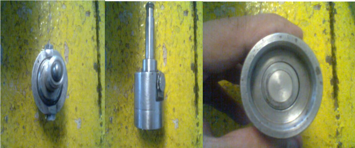
Fig.26 Porta pastilla y pastilla o disco de la válvula de seguridad.
