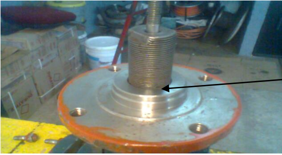
Fig.21 Válvula de seguridad sin el capuchón.
