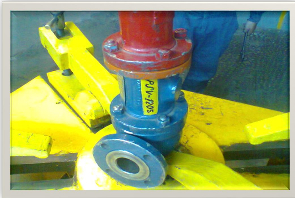
Fig.19 Válvula de seguridad (Instalación en el banco de prueba en el laboratorio de calibración de válvulas).
