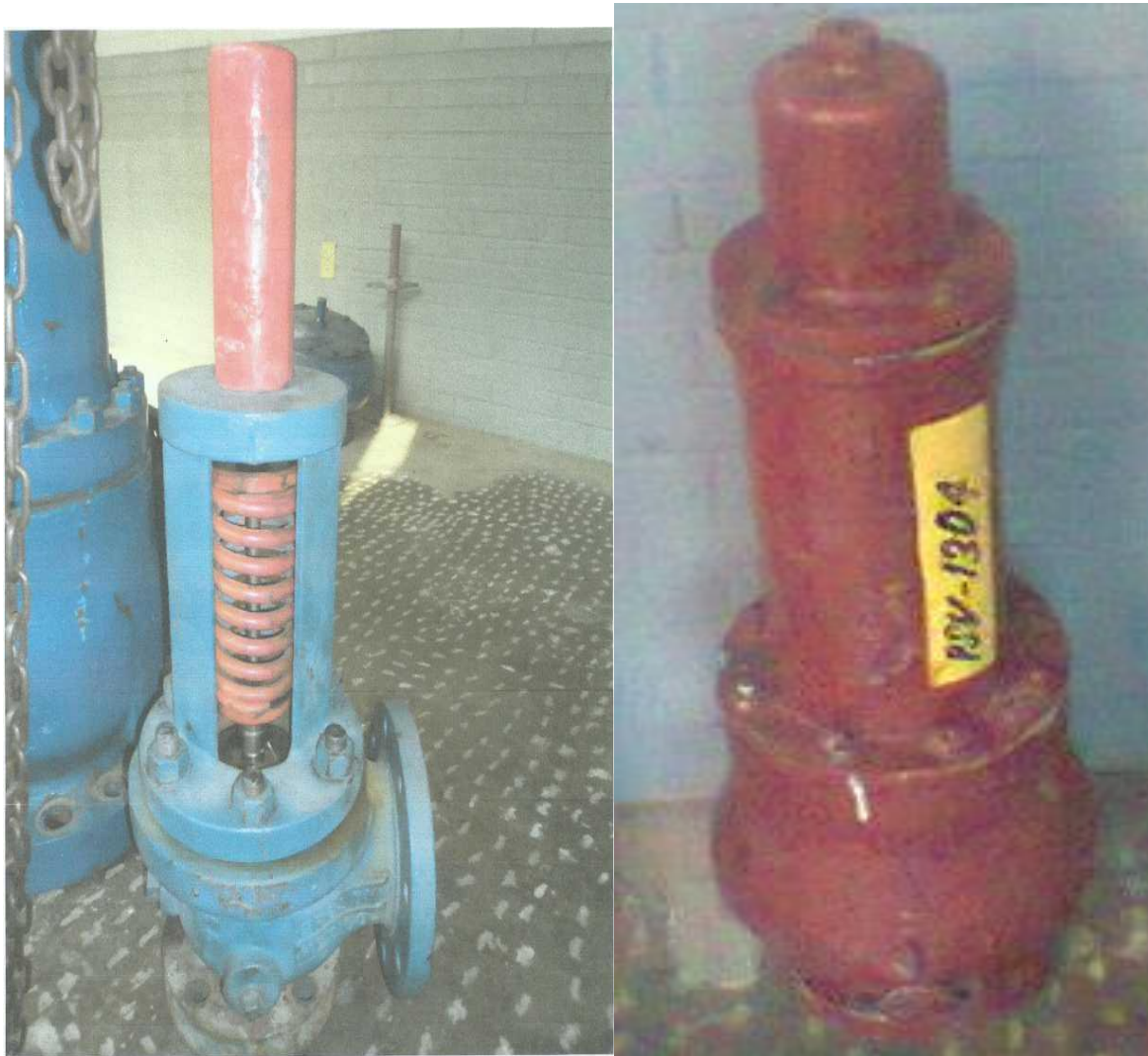
Fig. 34 Véase a continuación una válvula de seguridad de bonete abierto y cerrado.
