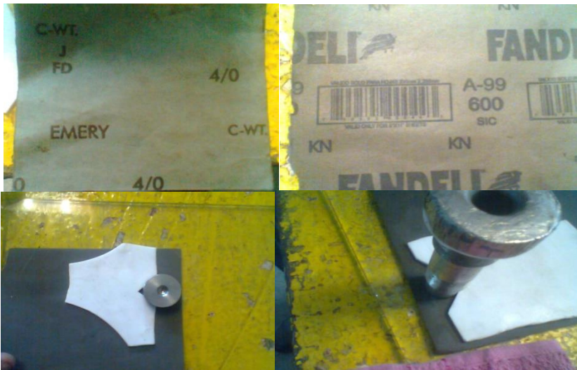
Fig.30 Tobera y pastilla eliminando impurezas por medio de lijas.
