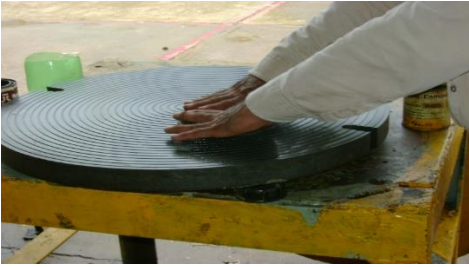
Fig. 29 Placa o plataforma para lapear.
