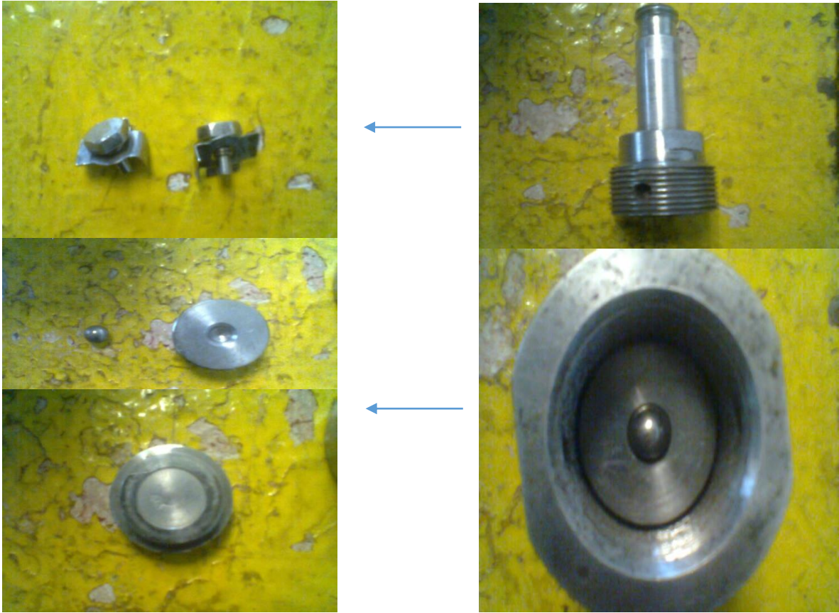
Fig.27 Desarmado de la porta pastilla de la válvula de seguridad.
