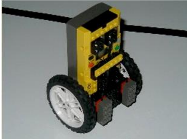
Figura 2.2.5 Péndulo invertido Legway.
