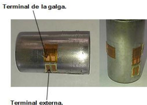
Figura 3.5 Extensómetros y terminales de conexión pegados en la superficie del separador.
