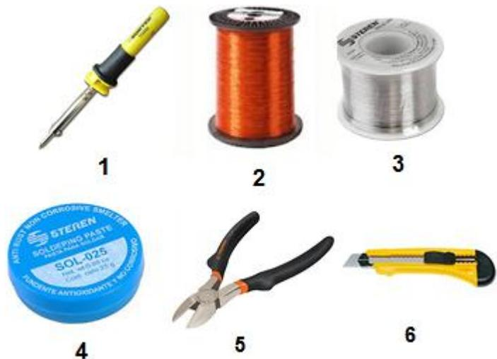
Figura 3.12 Material utilizado para el soldado del circuito. 1) Cautín tipo lápiz punta plana. 2) Alambre de cobre calibre 34. 3) Estaño 60/40 4) Pasta para soldar. 5) Pinza de corte diagonal. 6) Cúter.
