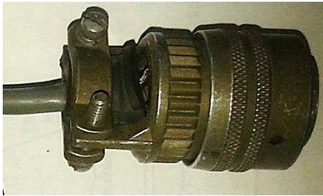
Figura 3.9 Terminal tipo Bendix PT06A-14-15-SR.
