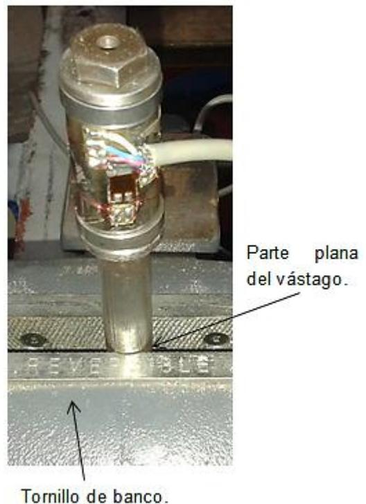
Figura 4.2 Elemento móvil montado en el tornillo de banco.
