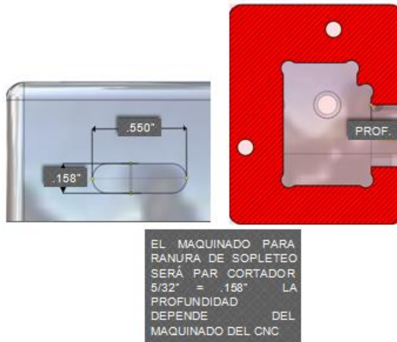
Figura 8.15 Maquinado para ranura de sopleteo
