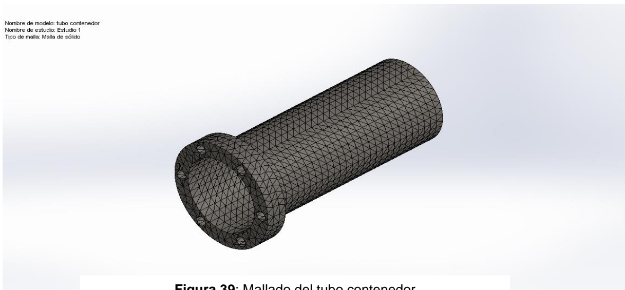
Figura 39: Mallado del tubo contenedor
