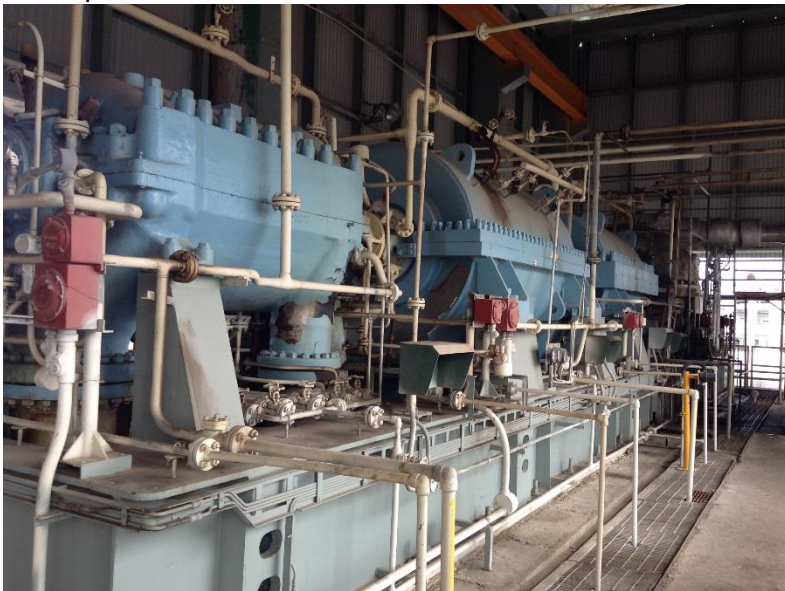
Ilustración 5-Compresor de 3 pasos GB-201
