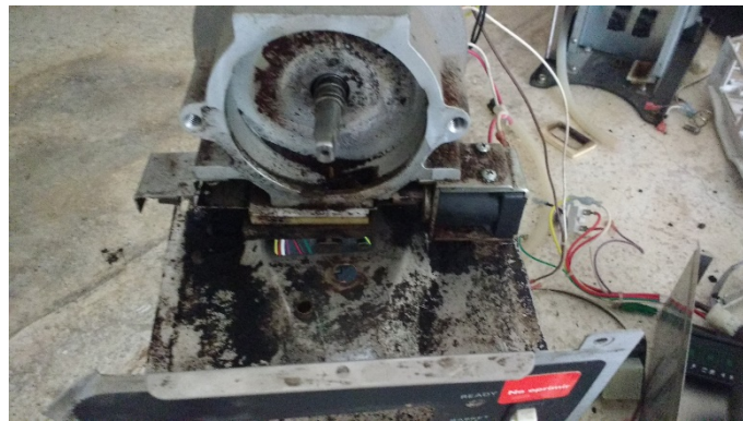
Imagen 1.2 Daño a molino por mal uso de herramientas
