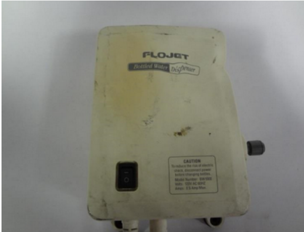
Imagen 1.6 Daño frontal por sobrecalentamiento
