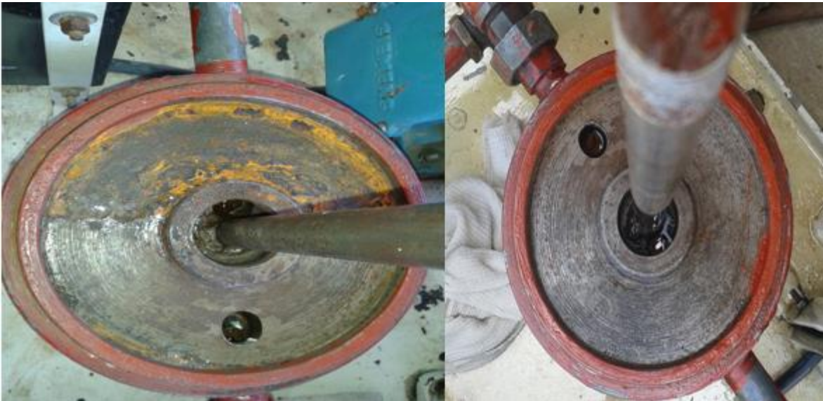
Figura 3. 10 Limpieza inferior del tanque principal
