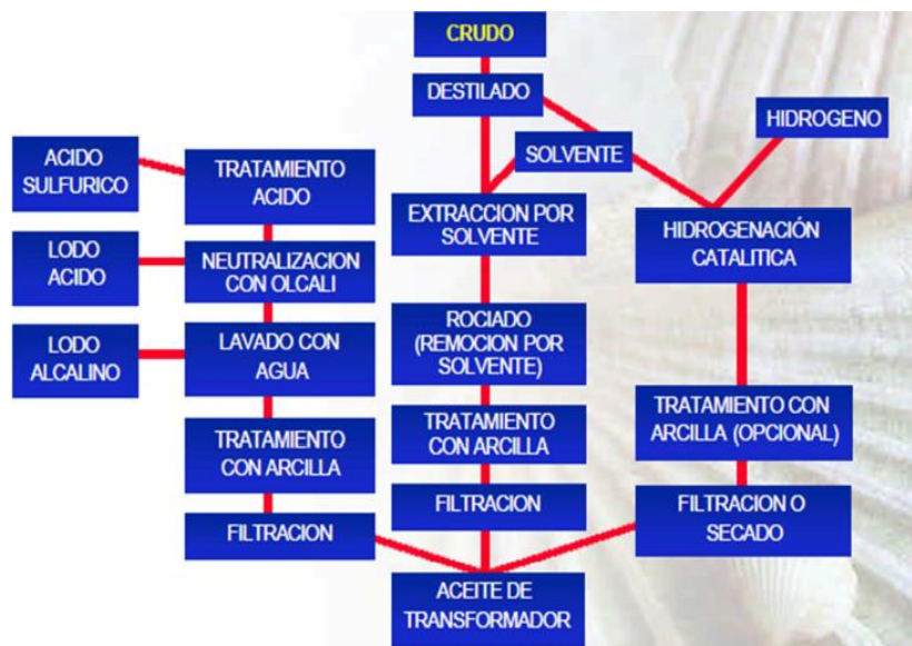
Figura 2. 15 Proceso de fabricación del aceite dieléctrico Fuente: (SHELL, 2011, pág. 24)
