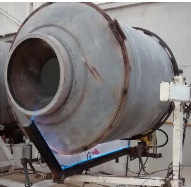
*Ilustración 4: Máquina de rotomoldeo a flama abierta. (Rotoinnovación SA de CV, 2015).*
