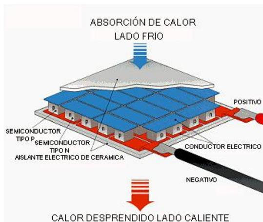
Ilustración 18: Estructura de un módulo Peltier.
