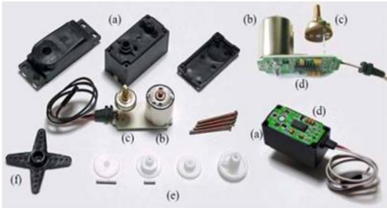
Figura 19.- Partes de un servomotor.
