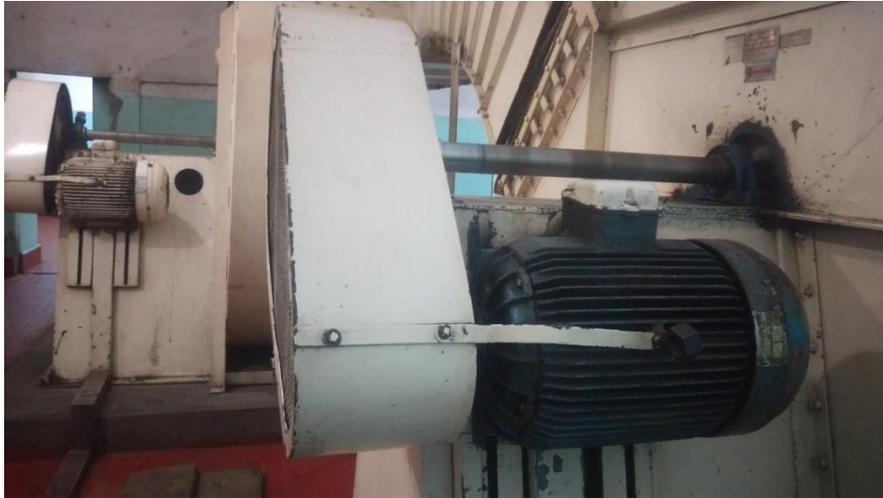
Figura 17 Motores de los ventiladores de la segunda etapa.
