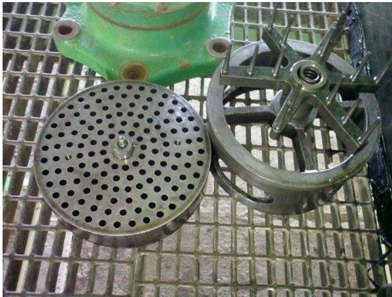
Fig. 35 Válvula de descarga del compresor BC-304-C
