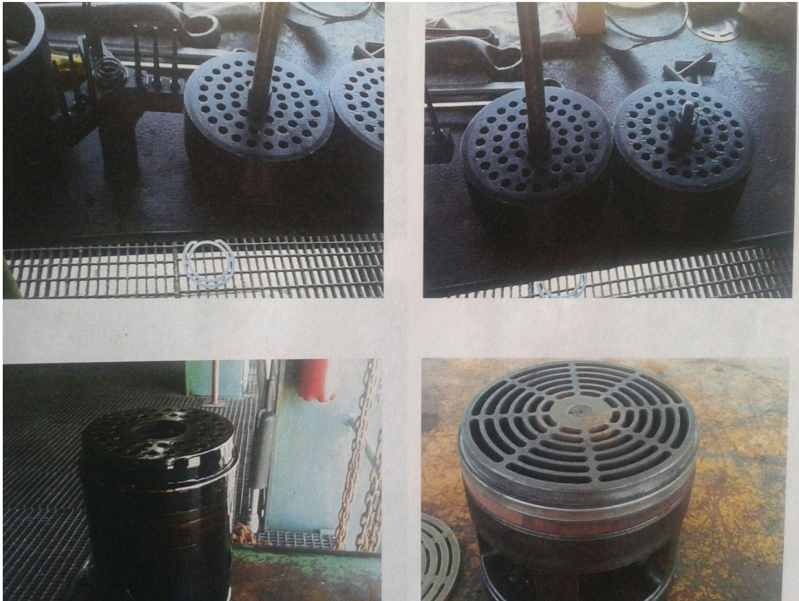
Fig. 52 Válvulas de succión de primer paso de compresor BC-301-A
