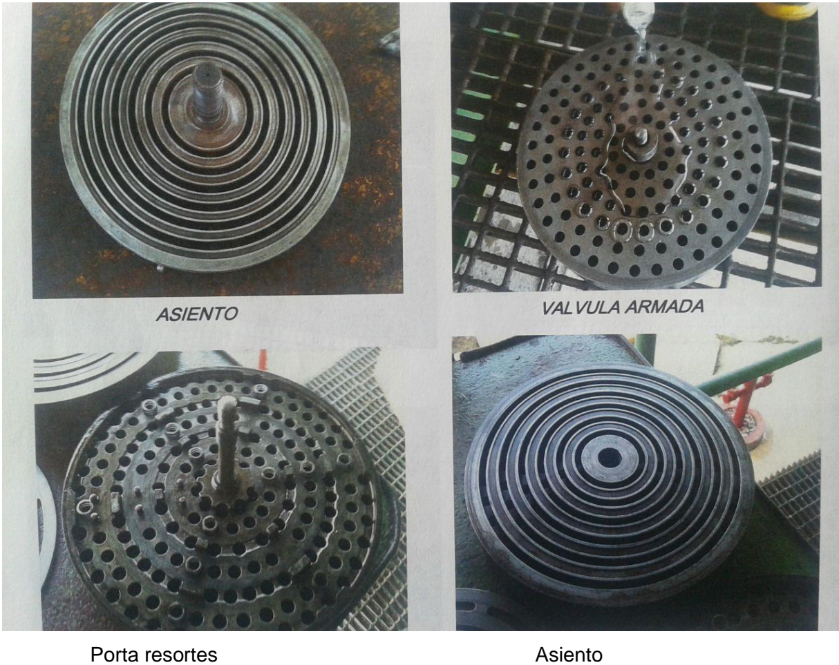
Fig. 53 Válvulas del compresor BC-304-C
