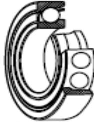
**Fig. 2.8.2.3 Rodamientos de bolas de contacto angular de una sola hilera**
