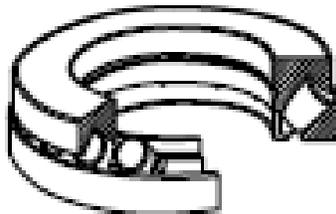
**Fig. 2.8.2.13 Rodamientos de rodillos esféricos de apoyo axial**
