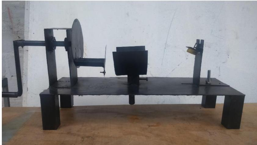
Fig. 4.2.1 Máquina cortadora de base de botellas PET
