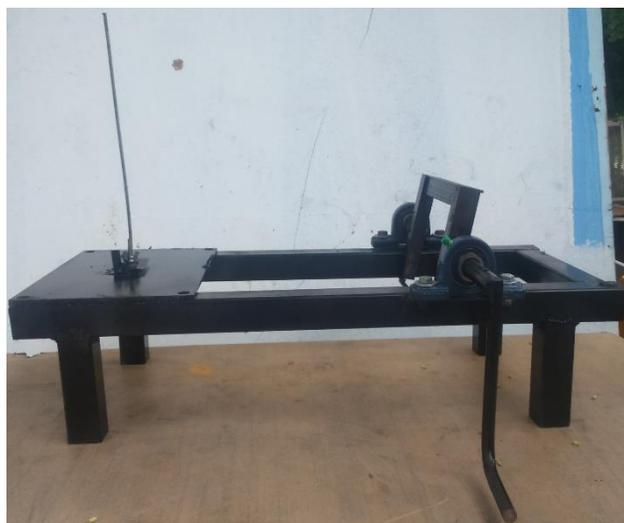
Fig. 4.3 Máquina cortadora de hilos de botellas
