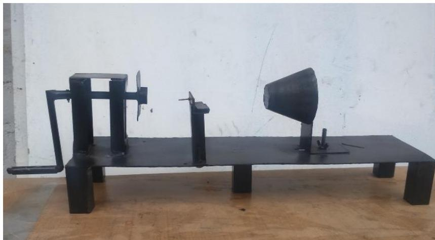
Fig. 4.2.2 Máquina cortadora de embudo de botellas PET
