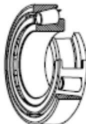
**Fig. 2.8.2.10 Rodamientos de rodillos cónicos**
