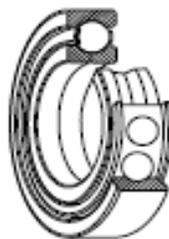
**Fig. 2.8.2.6 Rodamientos de bolas de cuatro puntos de contacto**
