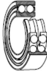
**Fig. 2.8.2.5 Rodamientos de bolas de contacto angular de hilera doble**
